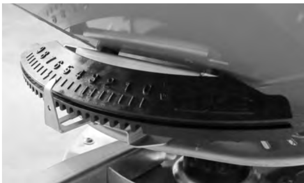
Obr. 35: Zobrazenie bodu dávkovania (príklad)
