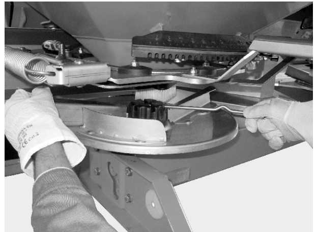
Obr. 32: Uvoľnenie uzavretej matice
