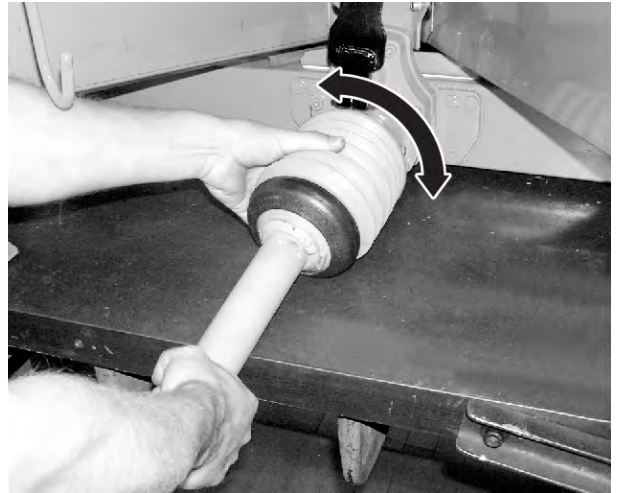
Obr. 13: Založenie ochranného krytu kĺbového hriadeľa
