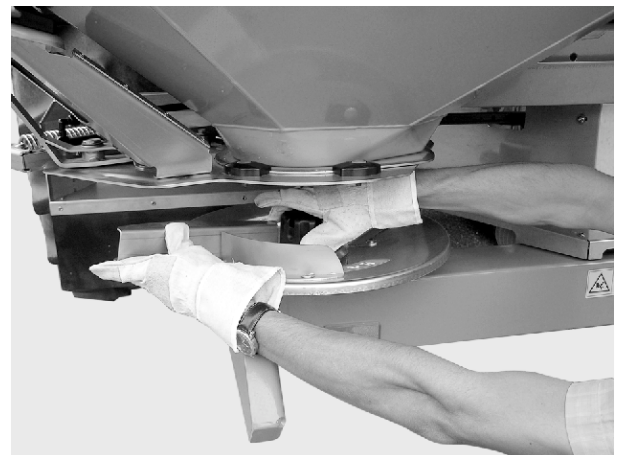
Obr. 33: Odskrutkovanie uzavretej matice
