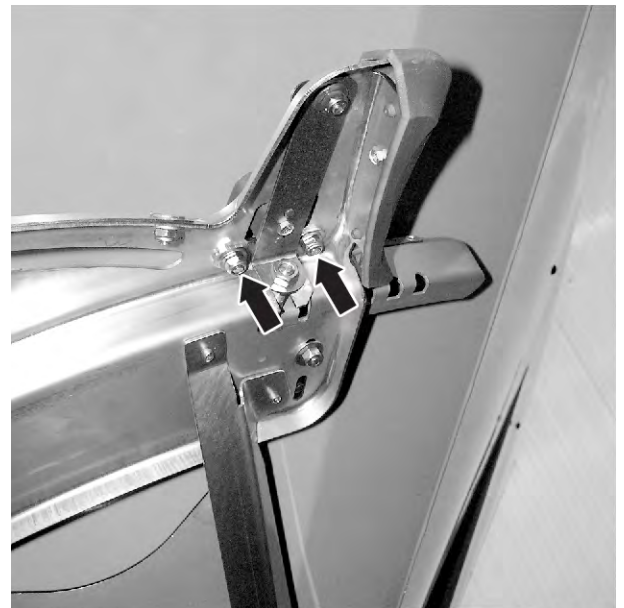
Obr. 65: Uvoľnenie nastavovacieho plechu bodu dávkovania
