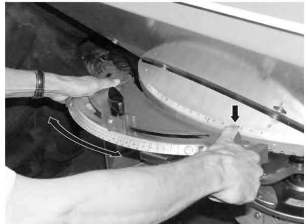
Obr. 34: Centrálne miesto na nastavenie bodu dávkovania
