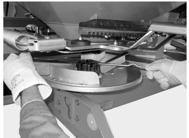
Pav. 43: Gaubiamosios veržlės atlaisvinimas
