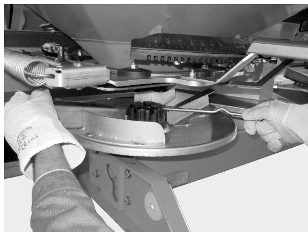
Pav. 33: Gaubiamosios veržlės atlaisvinimas
