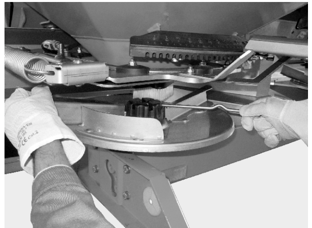
Pav. 33: Gaubiamosios veržlės atlaisvinimas
