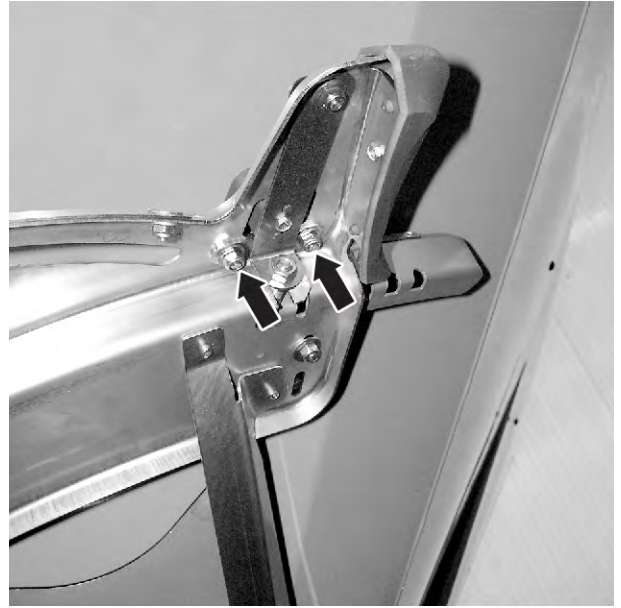
Ábr. 66: Feladási pont állítólemezeinek kioldása
