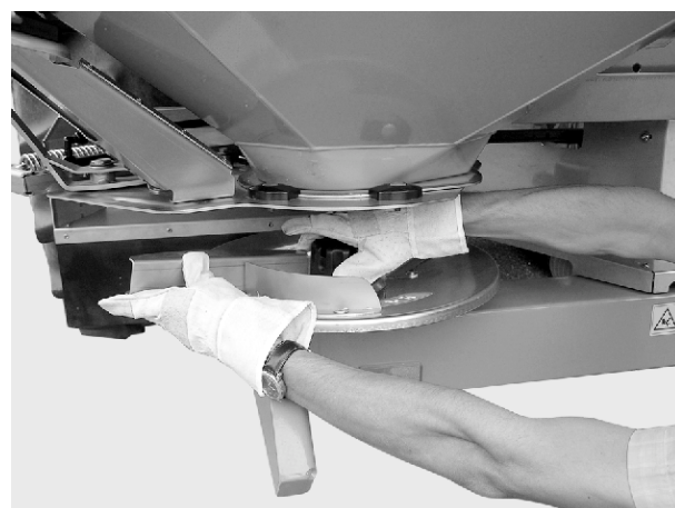
Sl. 34: Odvijanje slepe navrtke
