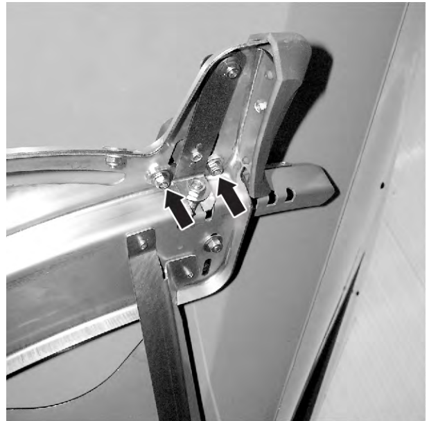
Sl. 70: Otpuštanje lima za fino podešavanje tačke za dodavanje materijala
