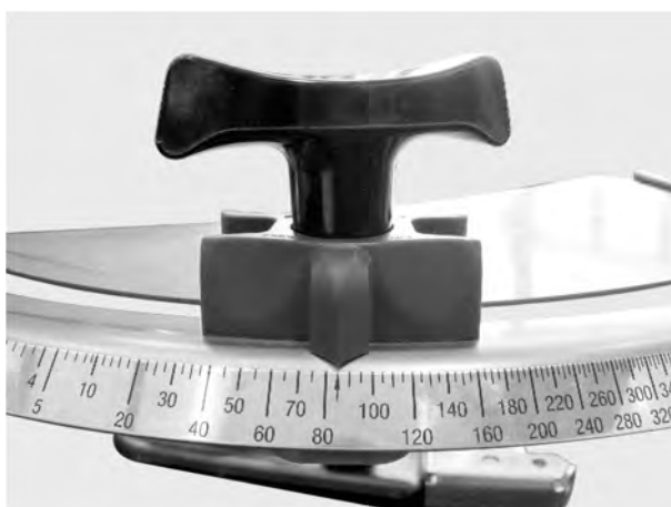
Рис. 62: Шкала для настройки заслонки дозатора
