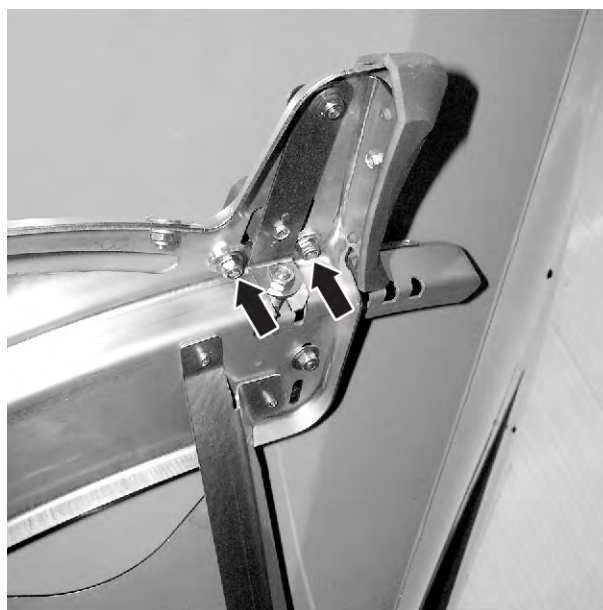
Рис. 66: Отсоединение юстировочной пластины точки подачи
