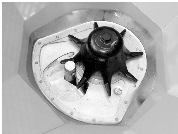
Рис. 61: Болт нижней тяги в дозировочном отверстии
