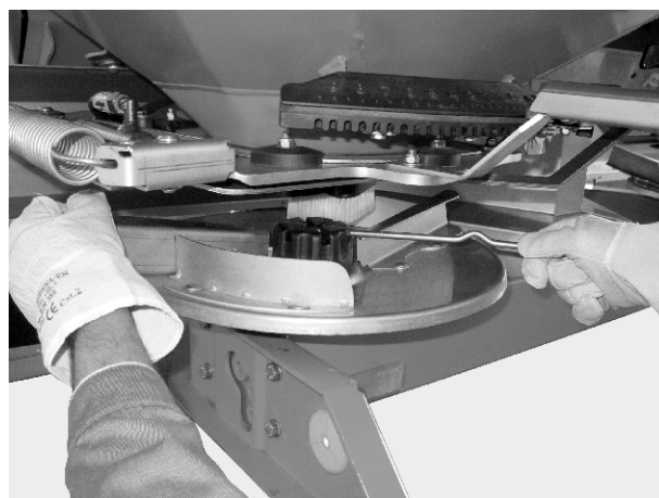
Рис. 33: Отвинчивание колпачковой гайки
