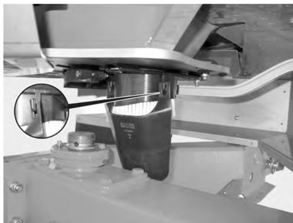
Рис. 44: Навешивание лотка для установки нормы внесения
