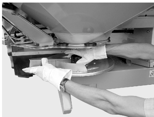
Obr. 46: Utažení uzavřené matice
