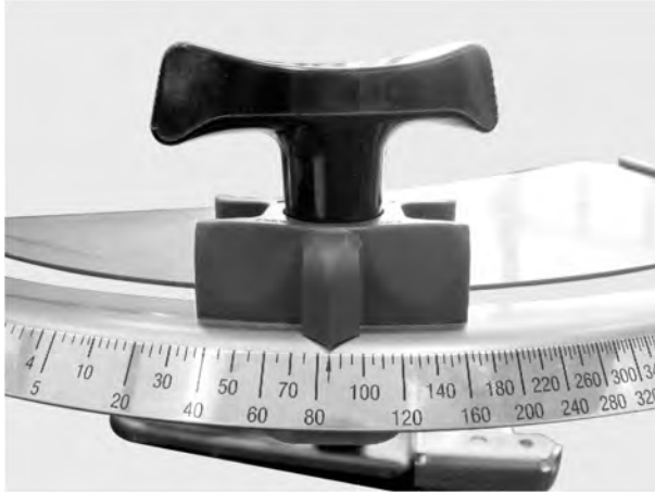
Obr. 62: Stupnice nastavení dávkovacího hradítka
