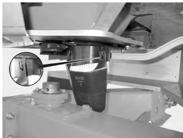
Obr. 44: Zavěšení žlabu na provedení zkoušky dávky
