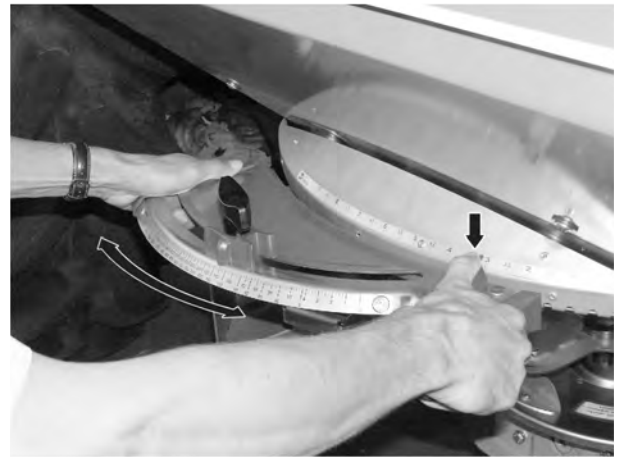
Fig. 34: Centru de reglare punct de alimentare
