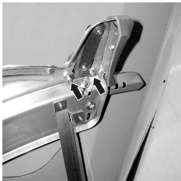
Mynd 65: Stillingarplata útrenslisstaðar losuð
