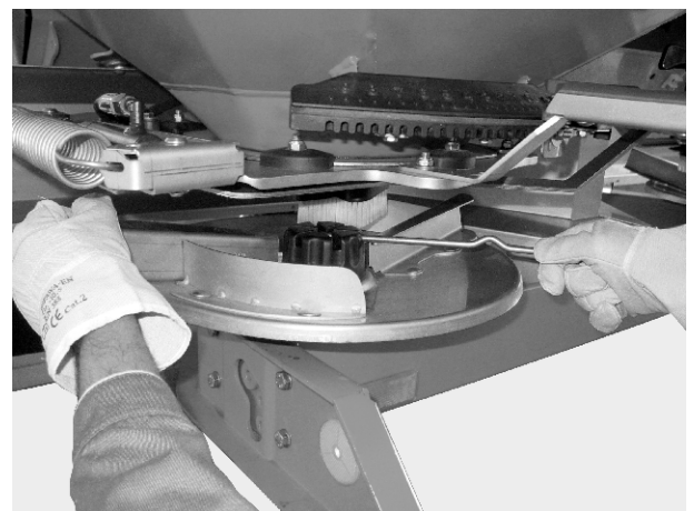
Σχ. 43: Χαλάρωση τυφλού παξιμαδιού
