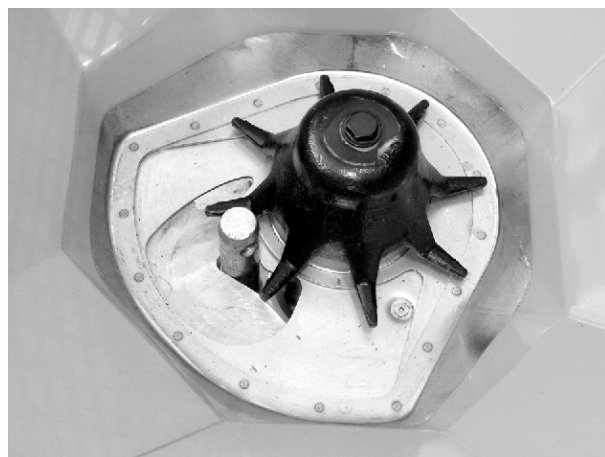
Фиг. 61: Болт на долния свързващ прът в дозирация отвор
