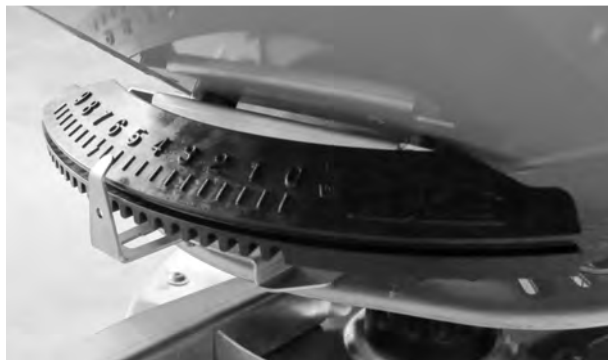
Фиг. 36: Индикатор за точката на подаване (пример)
