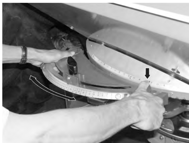
Фиг. 35: Регулировъчен център за точката на подаване
