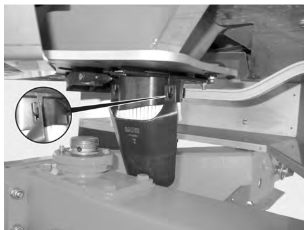
Фиг. 44: Закачване на улея за калибриране
