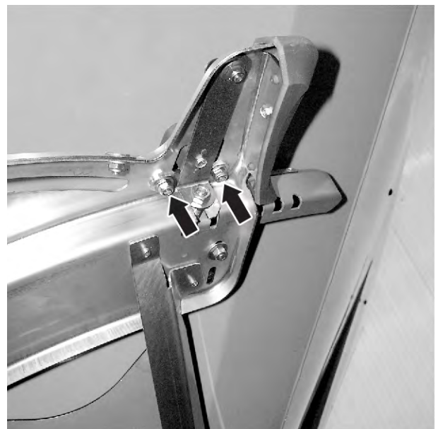
Фиг. 66: Освобождение на регулиращата пластинка за точката на подаване
