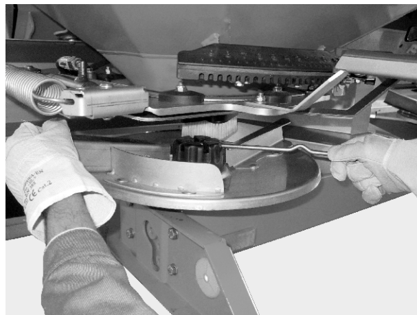
Фиг. 43: Развиване на глухата гайка
