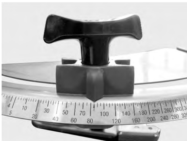
Фиг. 62: Скала за настройка на дозирация шибър
