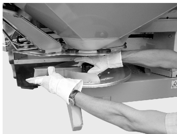
Rys. 34: Odkręcanie nakrętki kołpakowej
