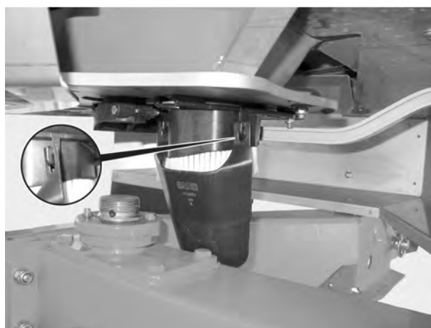
Rys. 44: Zawieszanie zsuwni do próby rozsiewu
