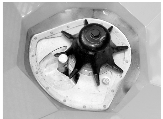
Rys. 61: Trzpień dolnego ramienia podnośnika w otworze dozującym
