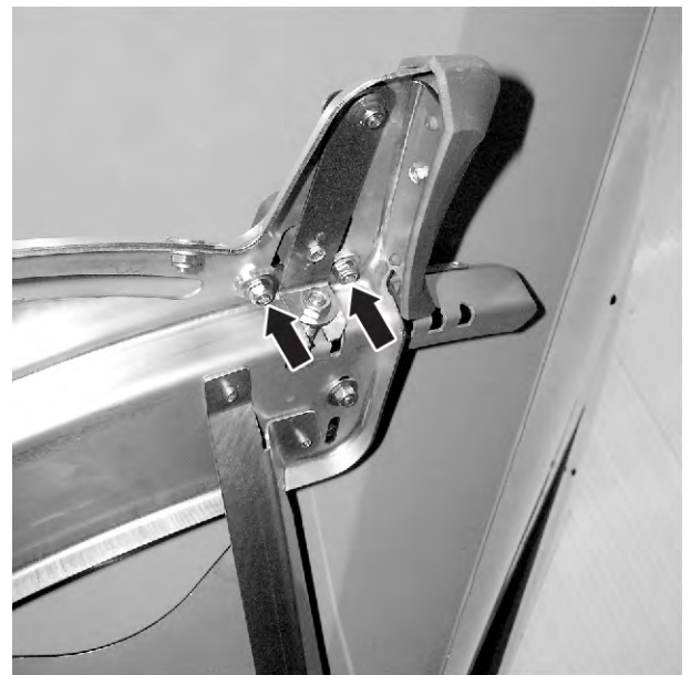
Rys. 66: Odkręcanie blachy regulacyjnej punktu dozowania
