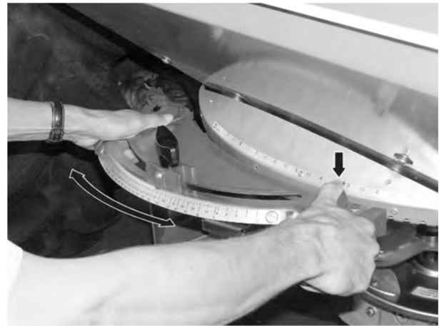
III. 35: Regolatore del punto di applicazione
