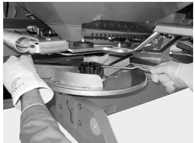
Fig. 33: Loosen the cap nut
