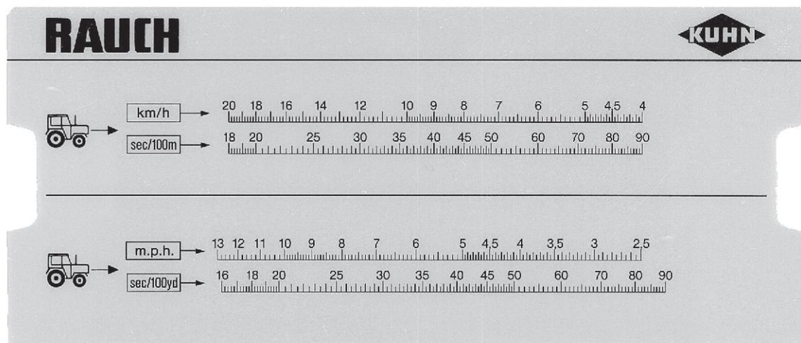
Fig. 40: Echelle pour le calcul de la vitesse d'avancement précise
