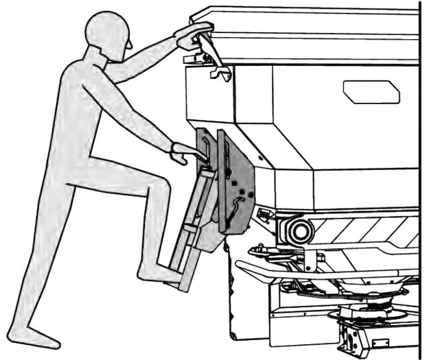
Fig. 49: Montée avec bâche de protection de la trémie
