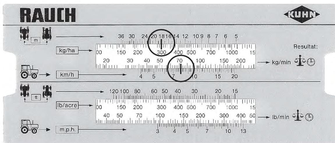
Fig. 41: Echelle pour le calcul de la quantité écoulée théorique par minute
