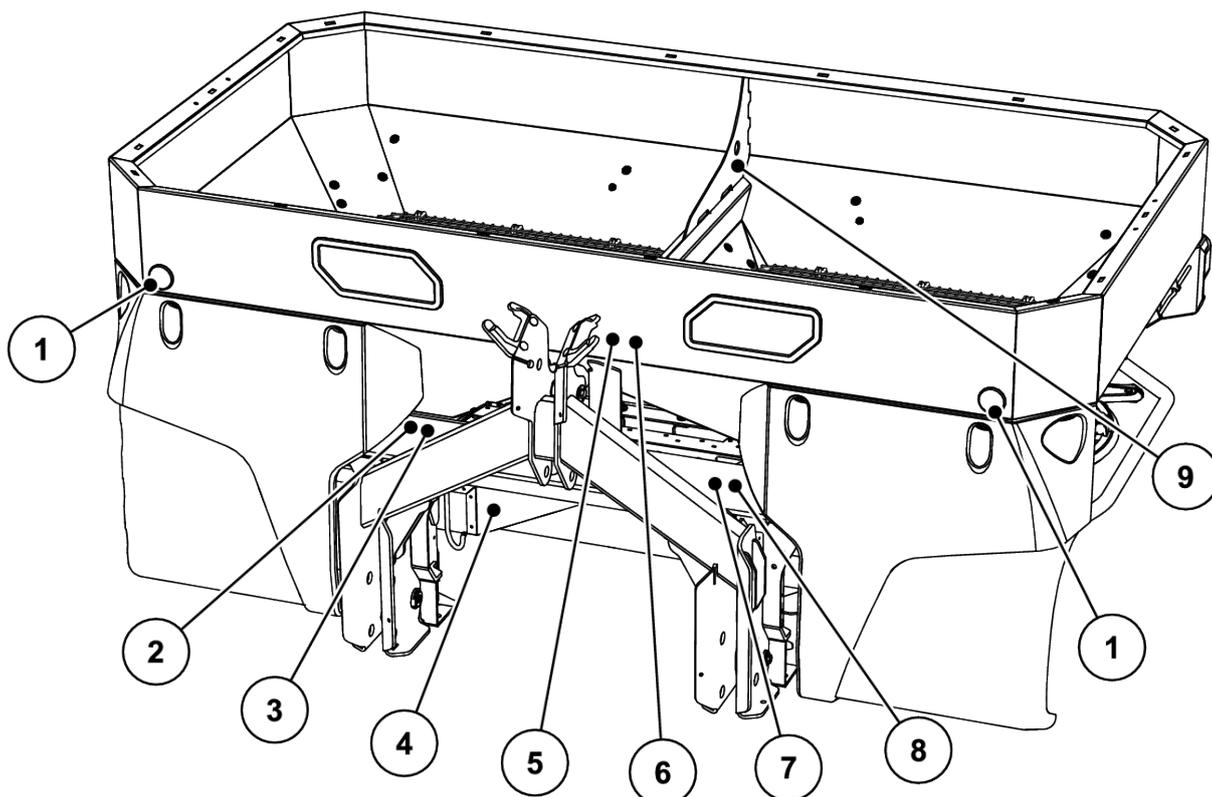
Fig. 4: Dispositifs de protection, autocollants d'avertissements et d'instructions, face avant
