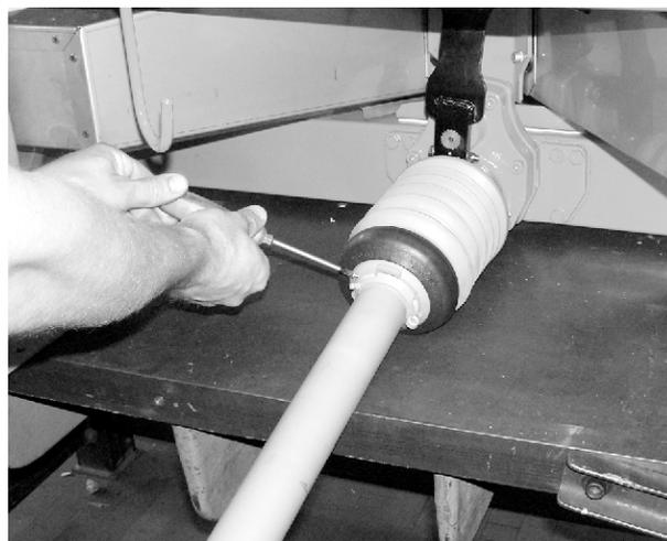
*Fig. 15: Bloquer la sécurité de l'arbre de transmission*
