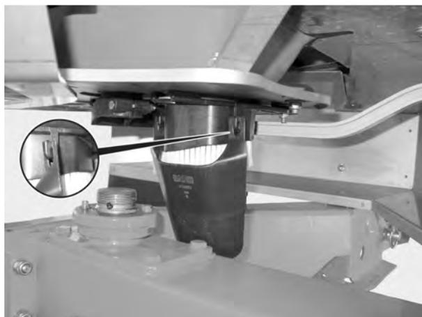
Fig. 44: Attacher la goulotte du contrôle de débit
