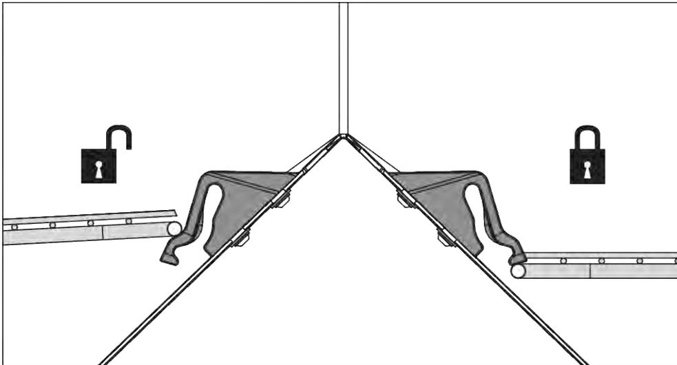
Fig. 55: Blocage de la grille de protection ouvert/fermé
