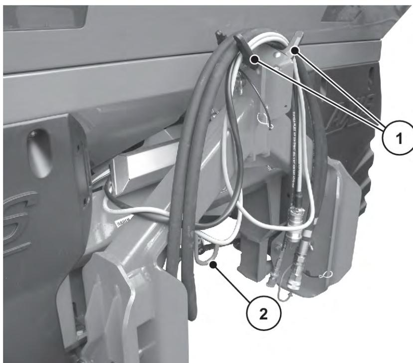
Fig. 47: Rangement des câbles et des tuyaux hydrauliques
