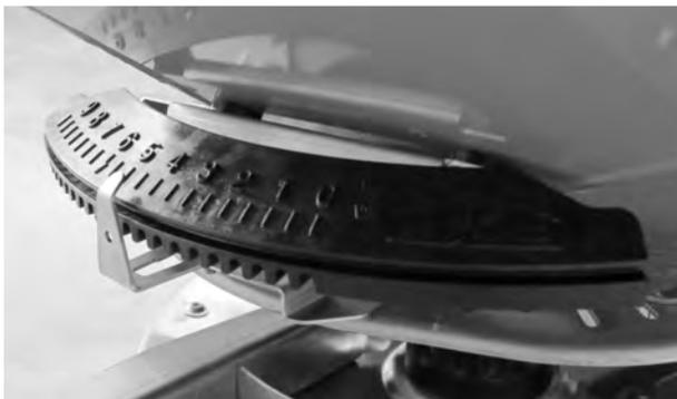
Fig. 36: Affichage du point de chute (exemple)
