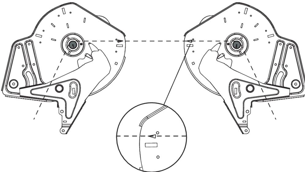
Fig. 69: Vérifier le réglage du point de chute
