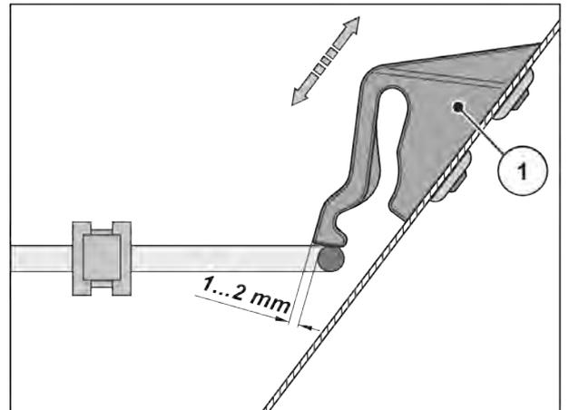
Fig. 57: Mesure de référence pour le contrôle de fonctionnement du verrouillage de la grille de protection
