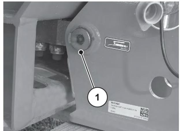
Fig. 73: Point de lubrification sur l'épandeur à pesée
