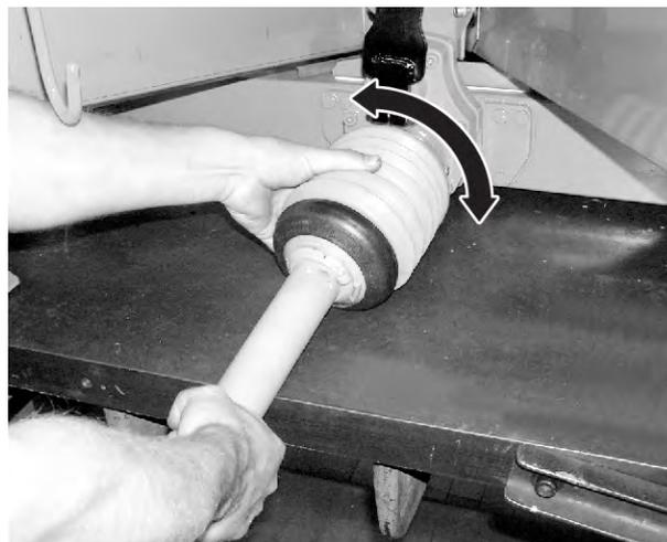
*Fig. 14: Installer la sécurité de l'arbre de transmission*
