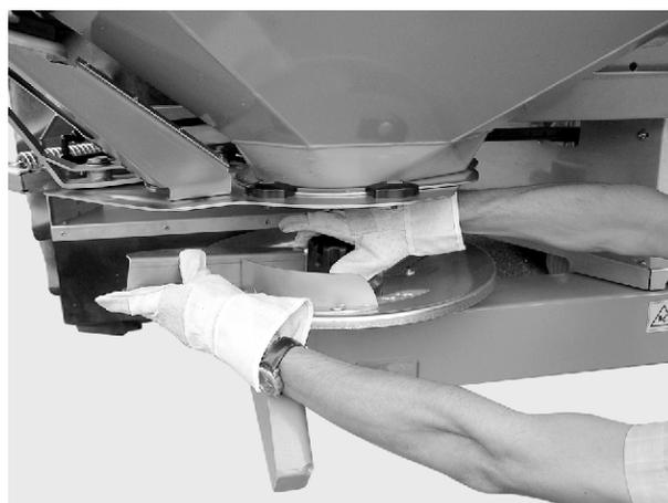
Fig. 46: Serrer l'écrou borgne
