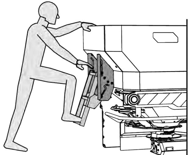
Fig. 48: Montée sans bâche de protection de la trémie
