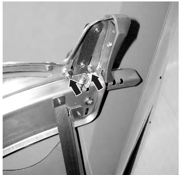
*Fig. 70: desserrer la tôle d'ajustage du point de chute*
