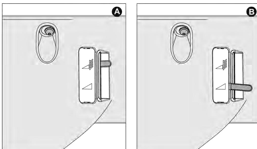
Fig. 31: TELIMAT Repère mécanique
