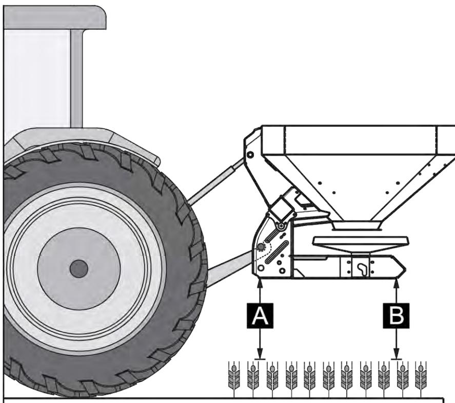
Fig. 20: Position et hauteur d'attelage en épandage normal
