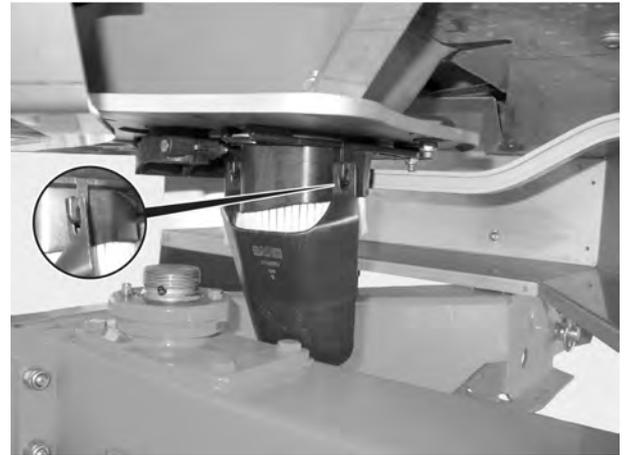
Abb. 44: Abdrehprobenrutsche einhängen
