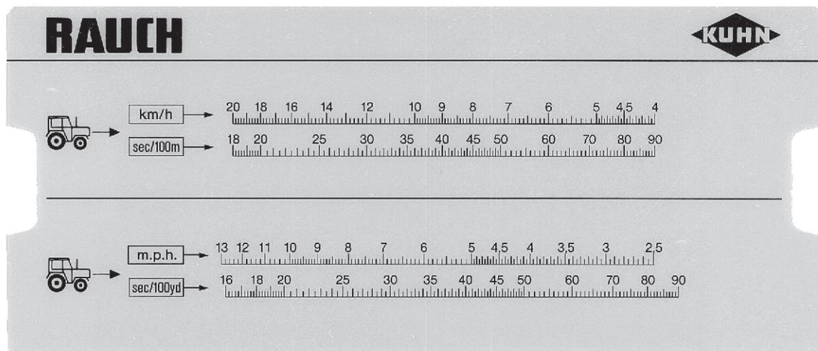
Abb. 40: Skala zur Ermittlung der genauen Fahrgeschwindigkeit
