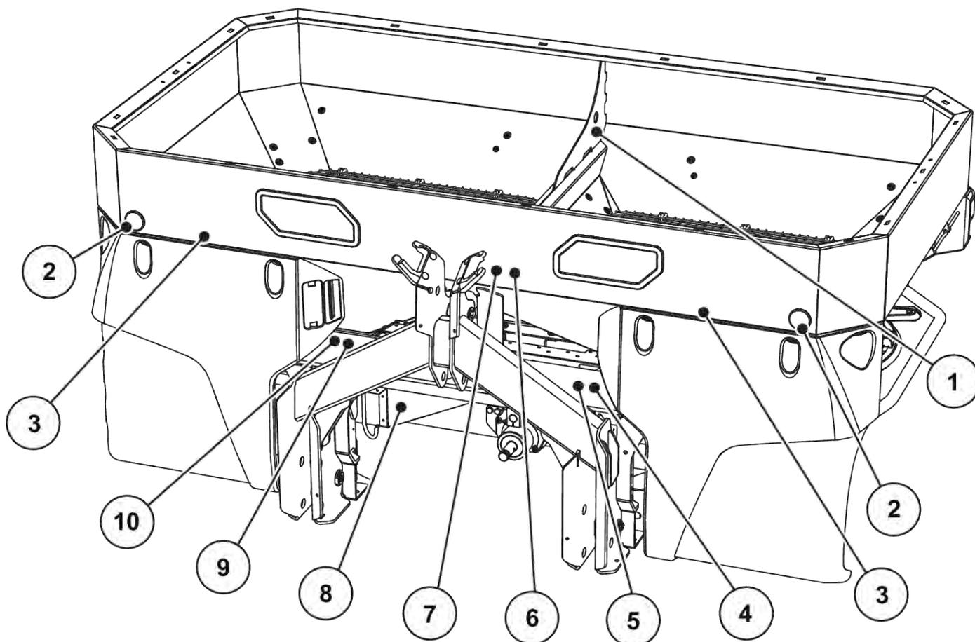
Abb. 2: Schutzeinrichtungen, Aufkleber Warn- und Instruktionshinweise, Vorderseite
