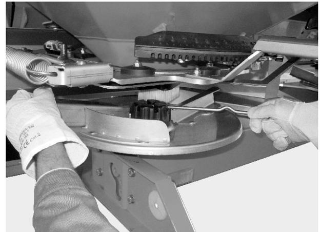
Abb. 43: Hutmutter lösen
