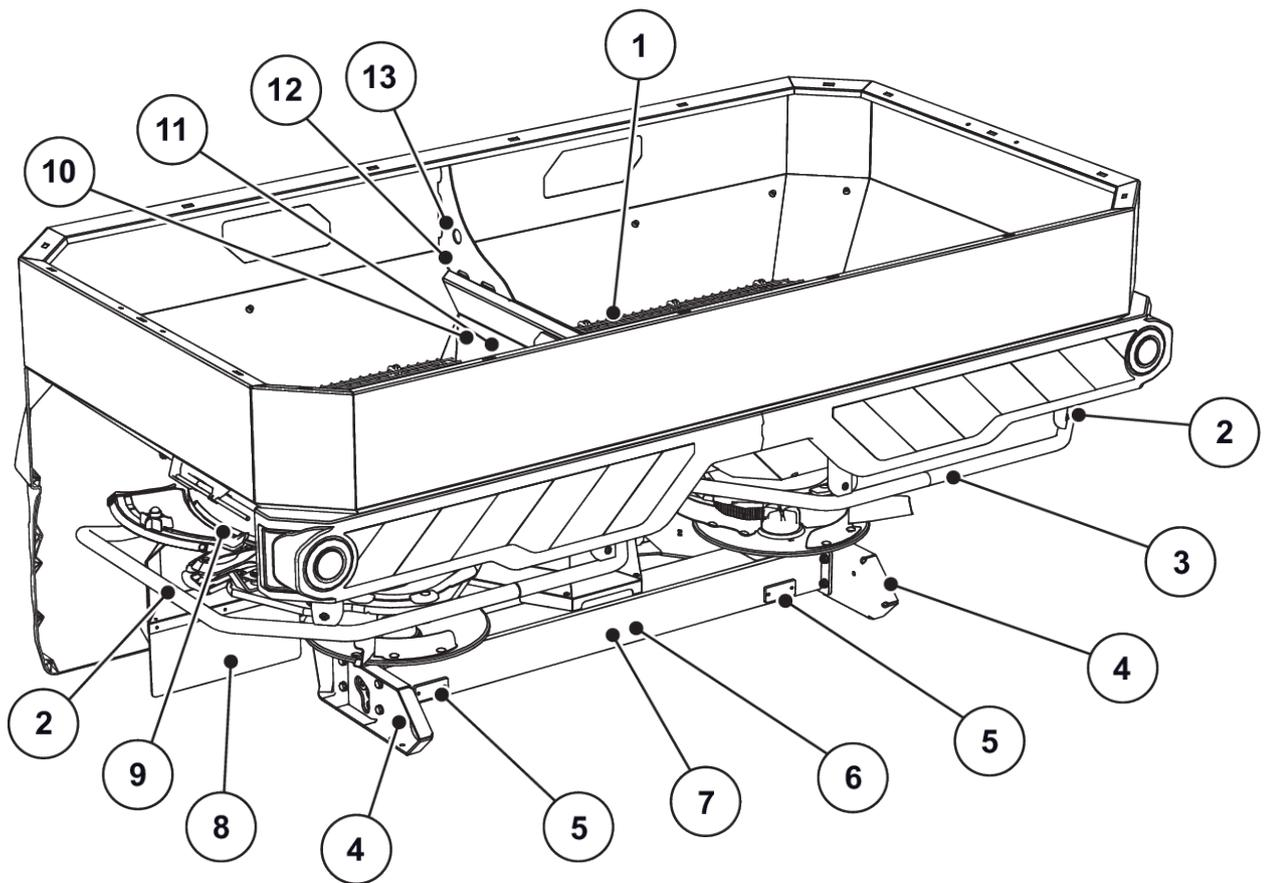
Abb. 3: Schutzeinrichtungen, Aufkleber Warn- und Instruktionshinweise, Rückseite
