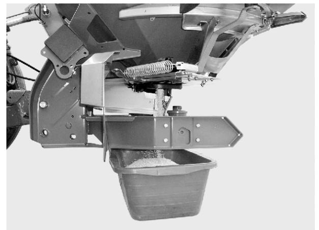
Abb. 45: Abdrehprobe durchführen
