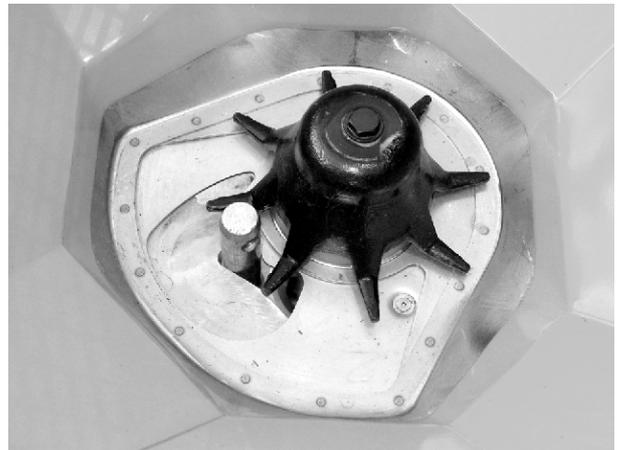
Abb. 65: Unterlenkerbolzen in Dosieröffnung
