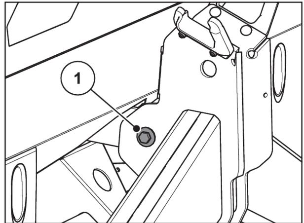
Abb. 53: Befestigung des Zugstabes am Wiegerahmen
