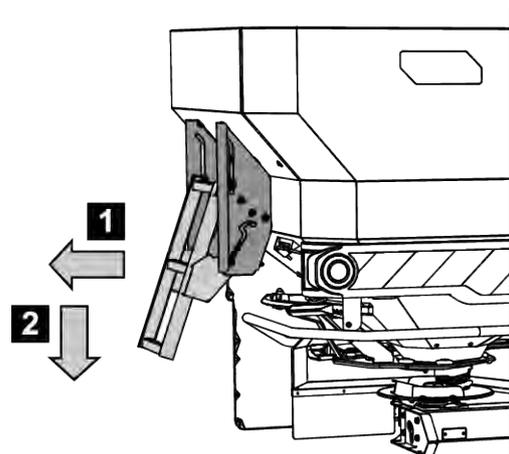
Abb. 50: Aufstieg ausklappen
