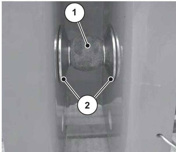
Abb. 17: Lage der Distanzscheiben beim Anbau der Maschine
