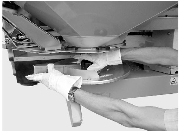
*Abb. 34: Hutmutter abschrauben*
