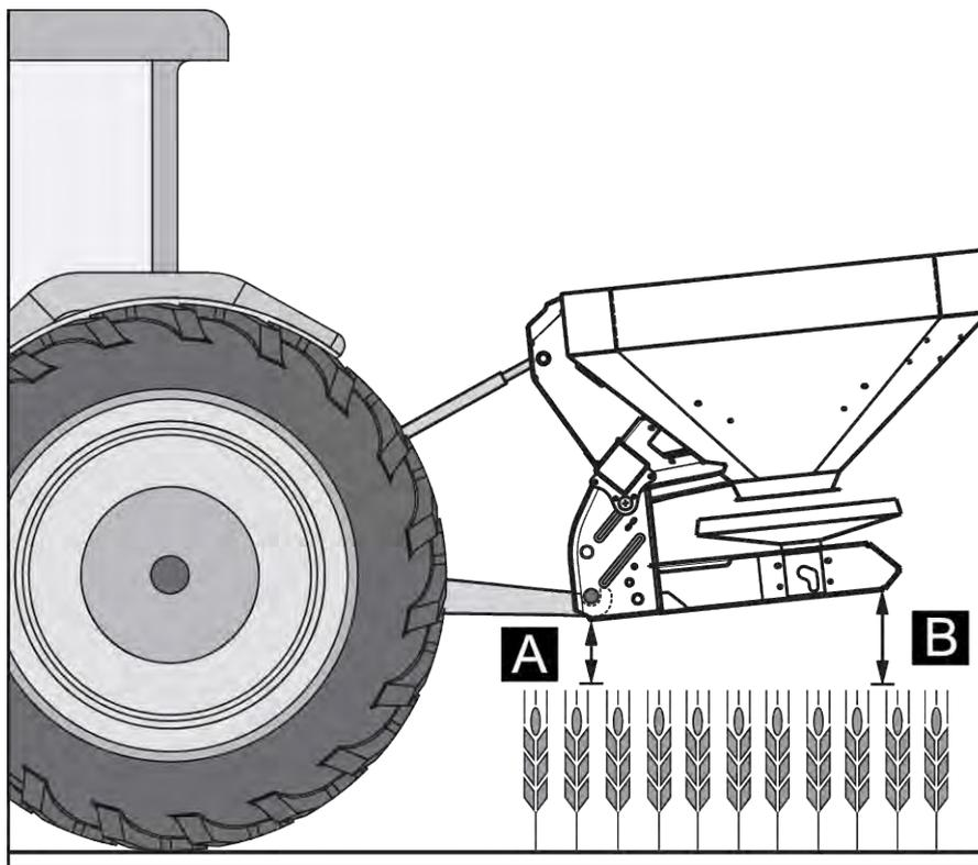
Abb. 22: Anbau der Maschine an den unteren Unterlenkerkuppelpunkt
