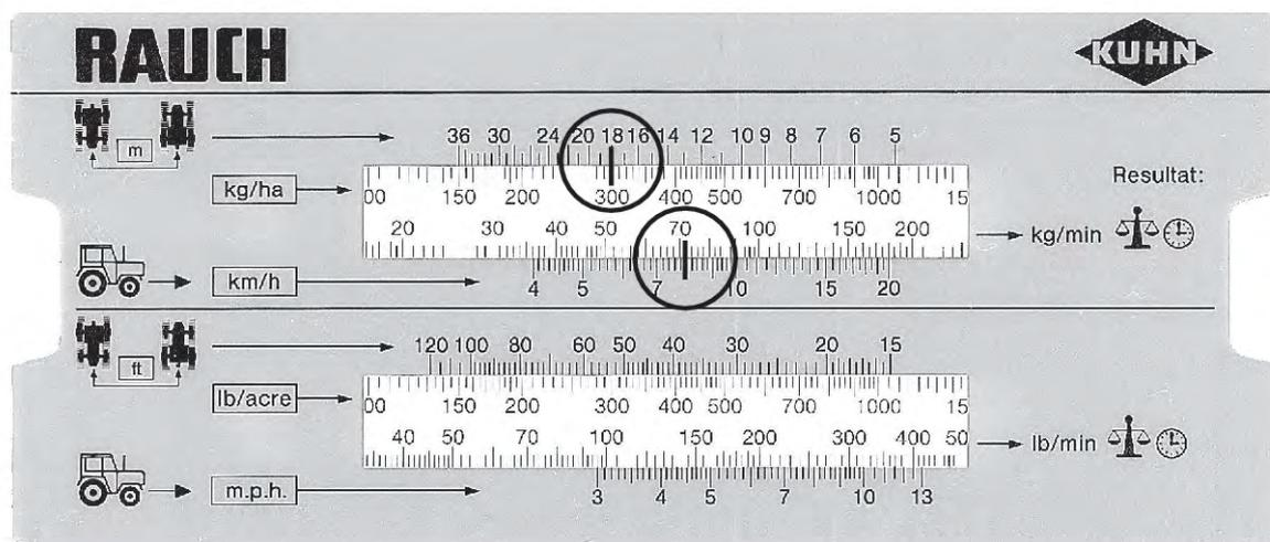
Abb. 41: Skala zur Ermittlung der Soll-Auslaufmenge pro Minute
