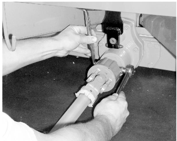
Abb. 13: Gelenkwelle befestigen
