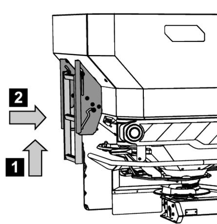
Abb. 51: Aufstieg in eingeklappter Stellung
