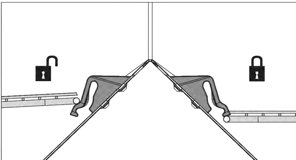
Abb. 55: Schutzgitterverriegelung offen/geschlossen
