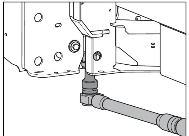
Abb. 52: Befestigung der Wiegezelle (in Fahrtrichtung links)
