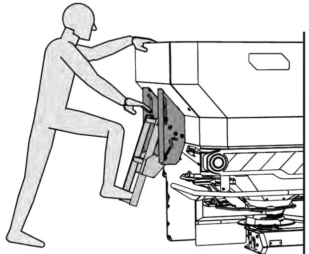
Abb. 48: Aufstieg ohne Behälterabdeckplane
