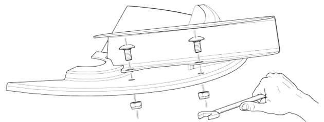
Abb. 63: Schrauben der Wurf Flügel lösen
