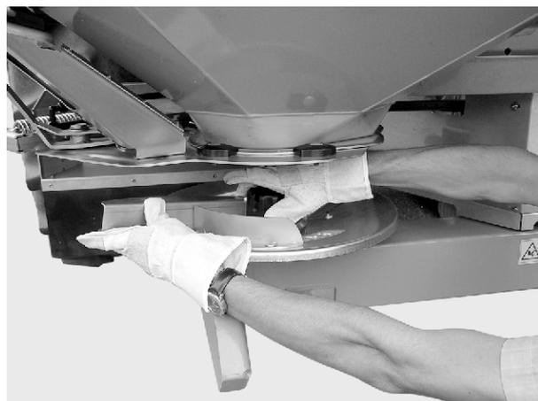
Abb. 46: Hutmutter anziehen
