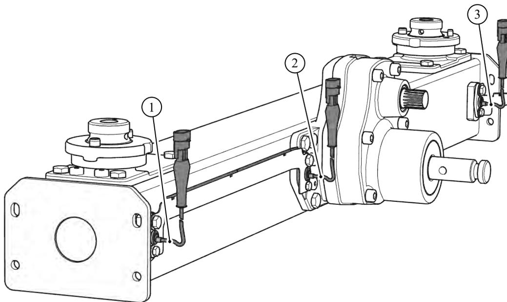
Abb. 8: Massenstromregelung durch Messung des Drehmoments der Wurfscheiben
