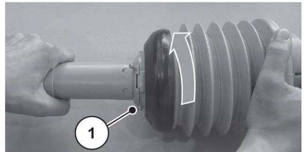
Abb. 11: Gelenkwellenschutz lösen
