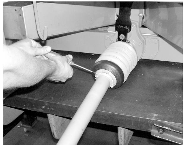
Abb. 15: Gelenkwellenschutz sichern
