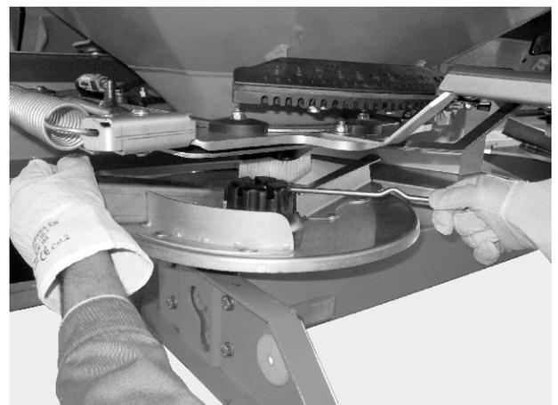
Abb. 33: Hutmutter lösen
