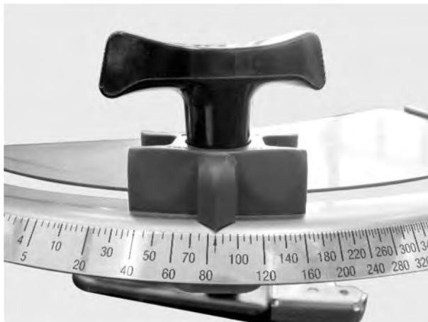
Рис. 66: Шкала для регулювання заслінки дозатора
