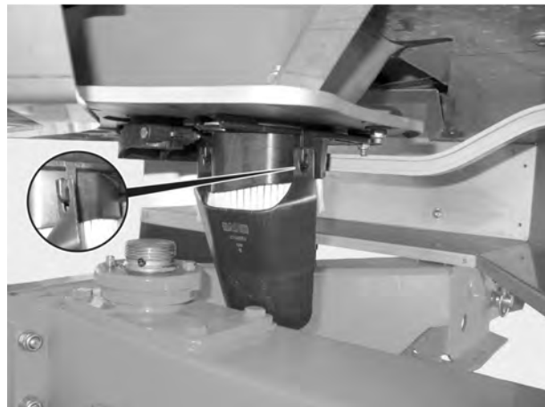
Рис. 48: Підвішування спускної труби для встановлення норми внесення добрива
