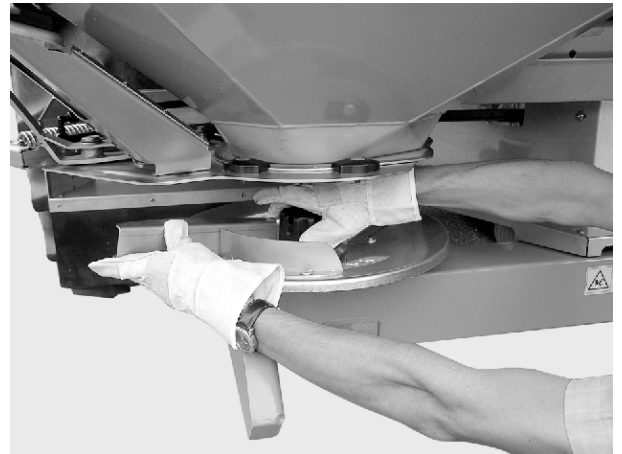
Рис. 50: Затягування ковпачкової гайки
