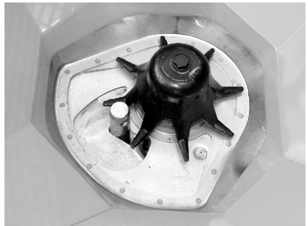
Рис. 65: Болт нижньої тяги в дозувальному отворі
