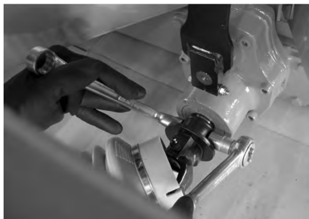
Рис. 13: Кріплення карданного вала
