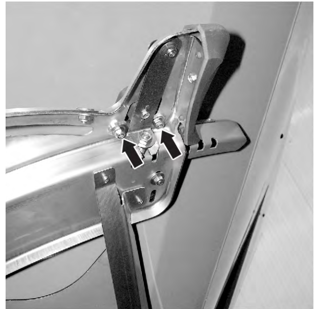
図 70: 放出ポイント調整プレートをゆるめる
