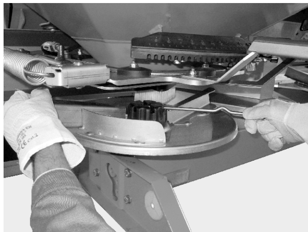
図 47: キャップナットをゆるめる
