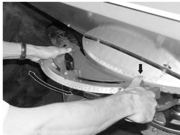
Att. 40: Padeves punkta iestatīšanas centrs
