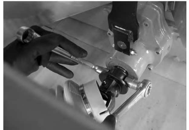
Att. 14: Kardānvārpstas nostiprināšana
