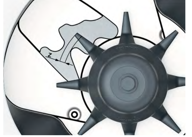
Şek. 61: Karıştırıcı kafasının aşınma bölgesi
