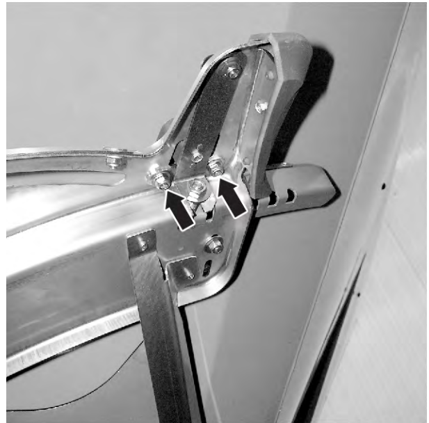
Sl. 71: Sprostitev nastavitvene pločevine točke dovajanja
