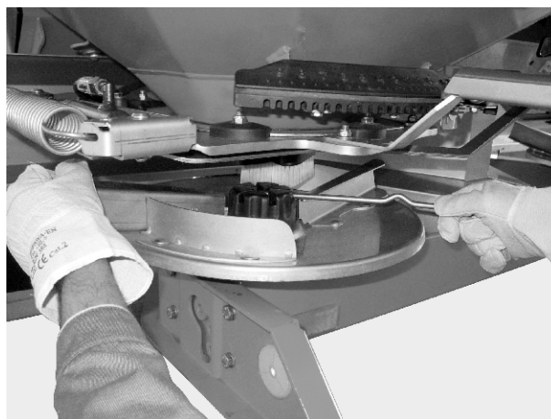
Obr. 37: Uvoľnenie uzavretej matice
