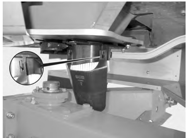
Obr. 48: Zavesenie sklzného žľabu na skúšobné rozmetávanie
