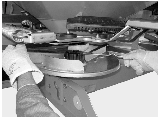
Obr. 47: Uvoľnenie uzavretej matice
