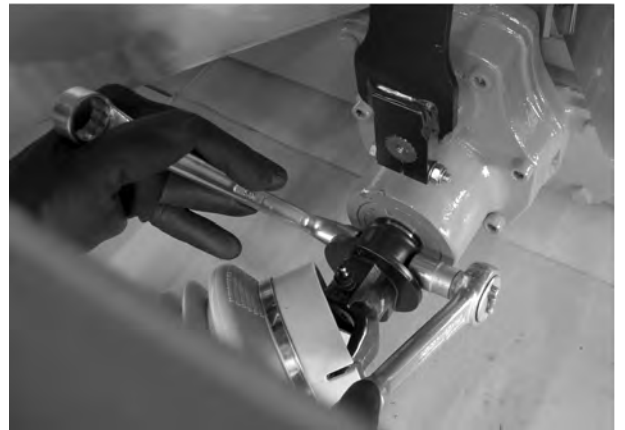
Pav. 14: Kardaninio veleno pritvirtinimas
