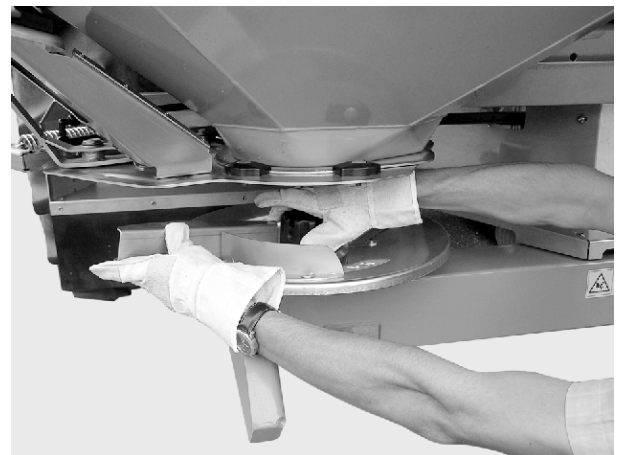
Pav. 39: Gaubiamosios veržlės atsukimas
