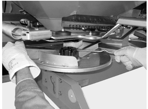
Pav. 38: Gaubiamosios veržlės atlaisvinimas
