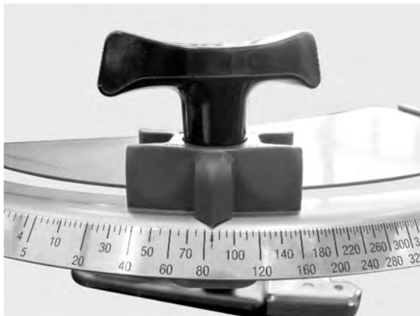
Pav. 67: Dozavimo sklendės nustatymo skalė
