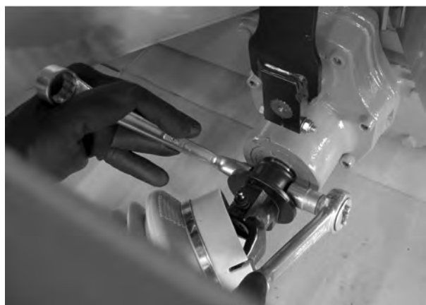
Jn. 13: Kardaanvõlli kinnitamine
