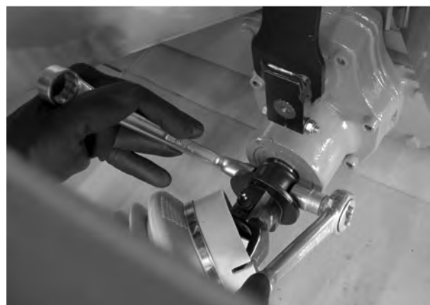
Sl. 14: Pričvršćivanje zglobnog vratila
