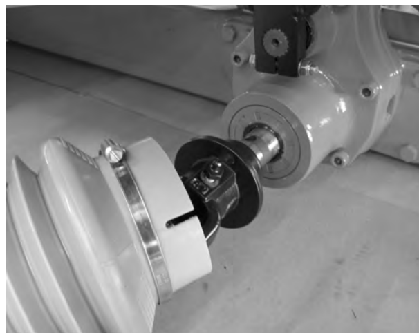
Sl. 13: Postavljanje zglobnog vratila na rukavac prenosnika
