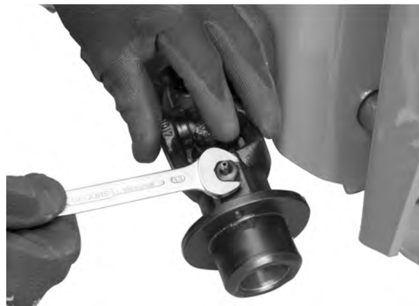
Sl. 12: Otpuštanje priključka za podmazivanje
