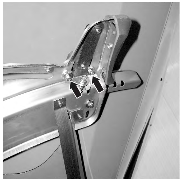
Ilust. 71: Soltar a chapa de ajuste do ponto de saída
