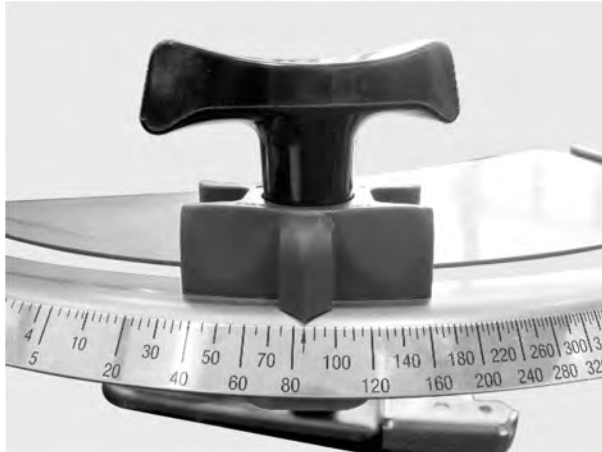
Ilust. 67: Ajuste da correção de dosagem da escala
