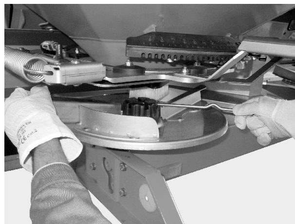
Рис. 48: Отвинчивание колпачковой гайки
