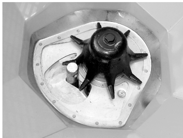
Fig. 66: Trekkstangbolt i doseringsåpning
