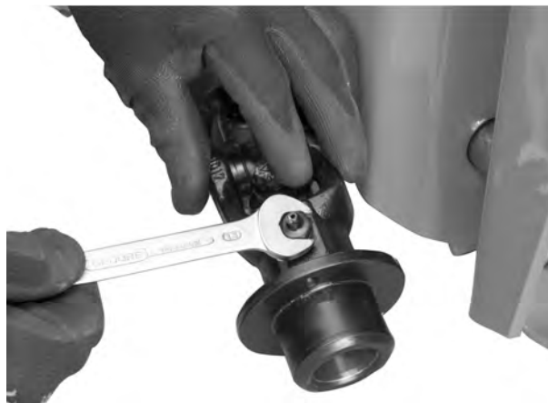
Sl. 12: Otpuštanje nazuvice za podmazivanje
