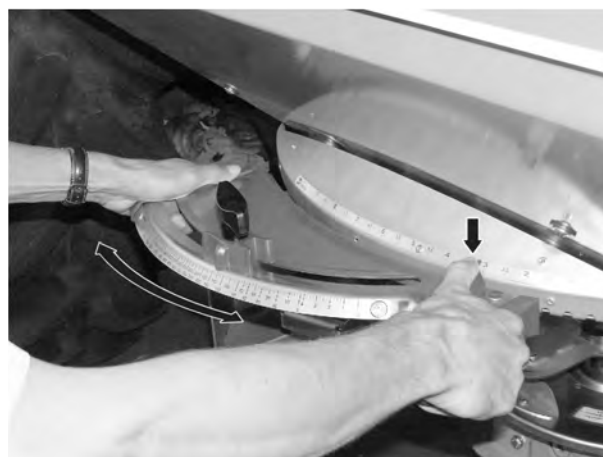
Sl. 40: Centar za namještanje točke za dodavanje materijala
