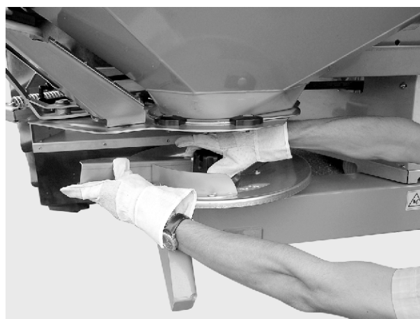
Sl. 51: Pritezanje zaobljene slijepne matice
