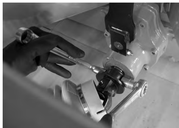
Fig. 14: Fastgørelse af kardanaxslen
