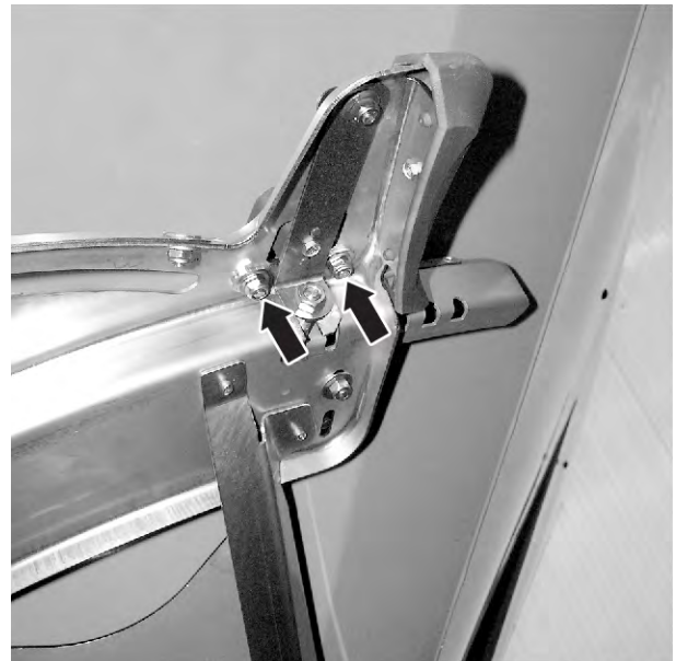
Fig. 70: Slăbirea plăcii de ajustare pentru punctul de alimentare
