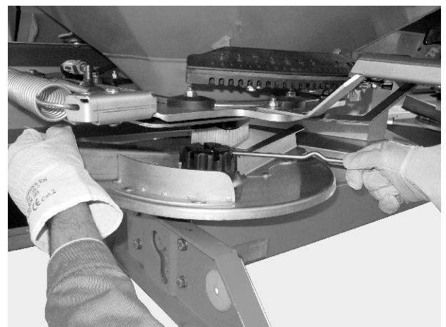
Σχ. 48: Χαλάρωση τυφλού παξιμαδιού
