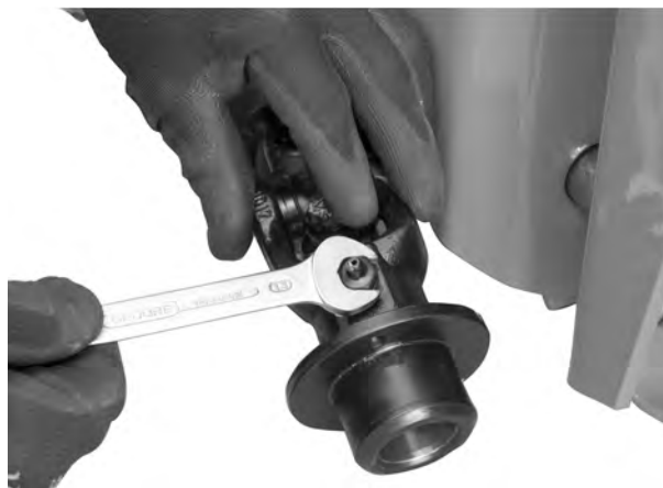
Σχ. 12: Χαλάρωση στομίου λίπανσης
