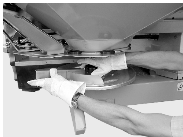
Rys. 39: Odkręcanie nakrętki kołpakowej
