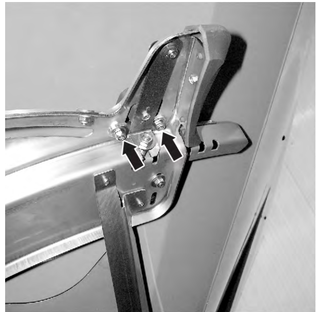
Rys. 71: Odkręcanie blachy regulacyjnej punktu dozowania
