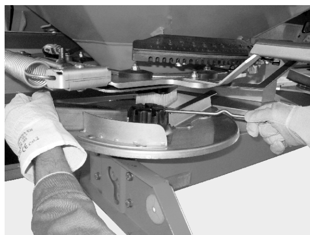
Rys. 38: Luzowanie nakrętki kołpakowej
