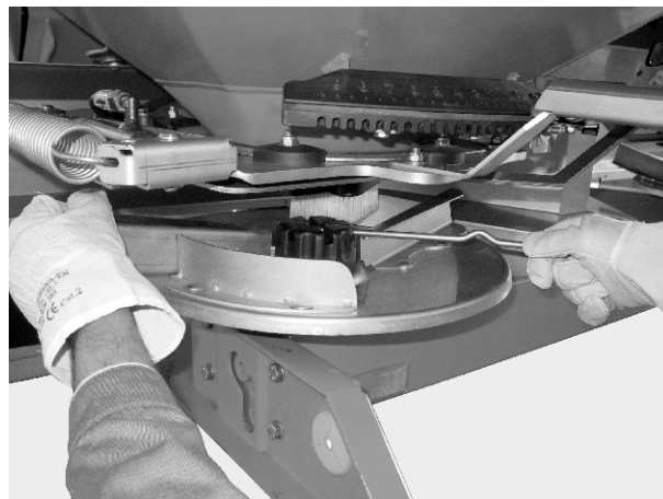
Rys. 48: Luzowanie nakrętki kołpakowej
