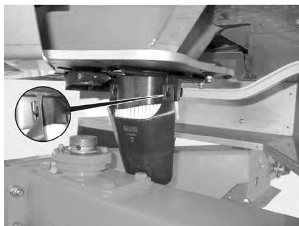
Rys. 49: Zawieszanie zsuwni do próby rozsiewu
