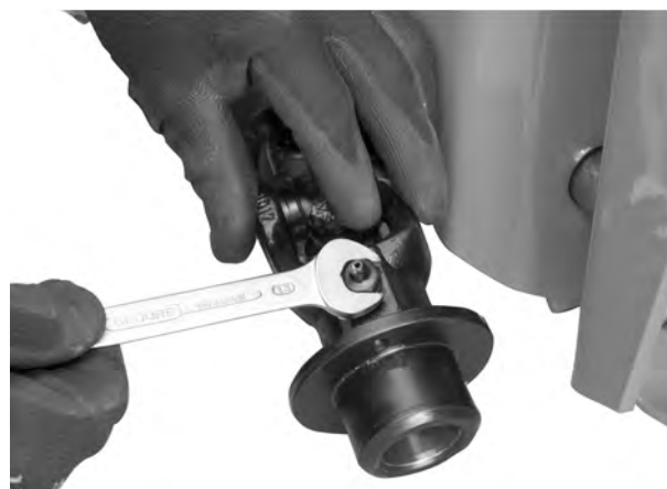
III. 12: Svitare il raccordo per lubrificazione
