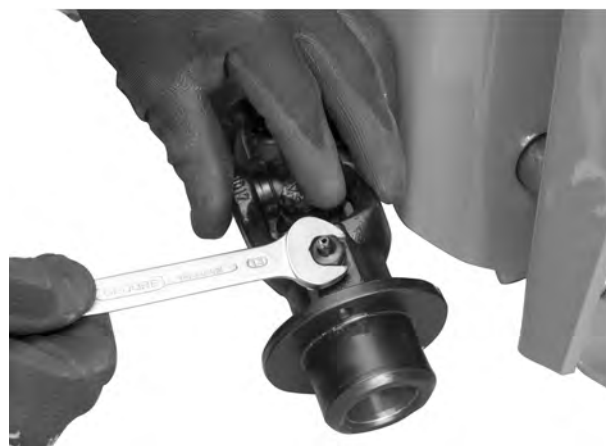
Fig. 12: Desserrer le graisseur
