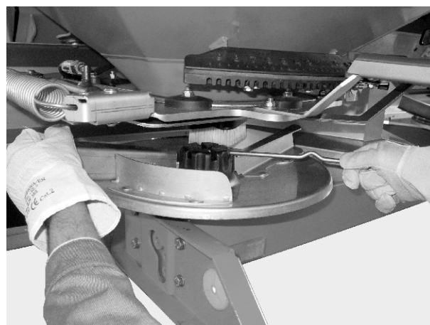
Fig. 48: Desserrer l'écrou borgne
