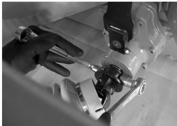
Fig. 14: Fixer l'arbre articulé
