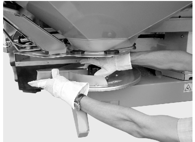
Fig. 51: Serrer l'écrou borgne
