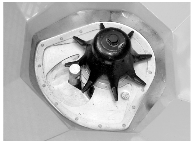
Abb. 66: Unterlenkerbolzen in Dosieröffnung
