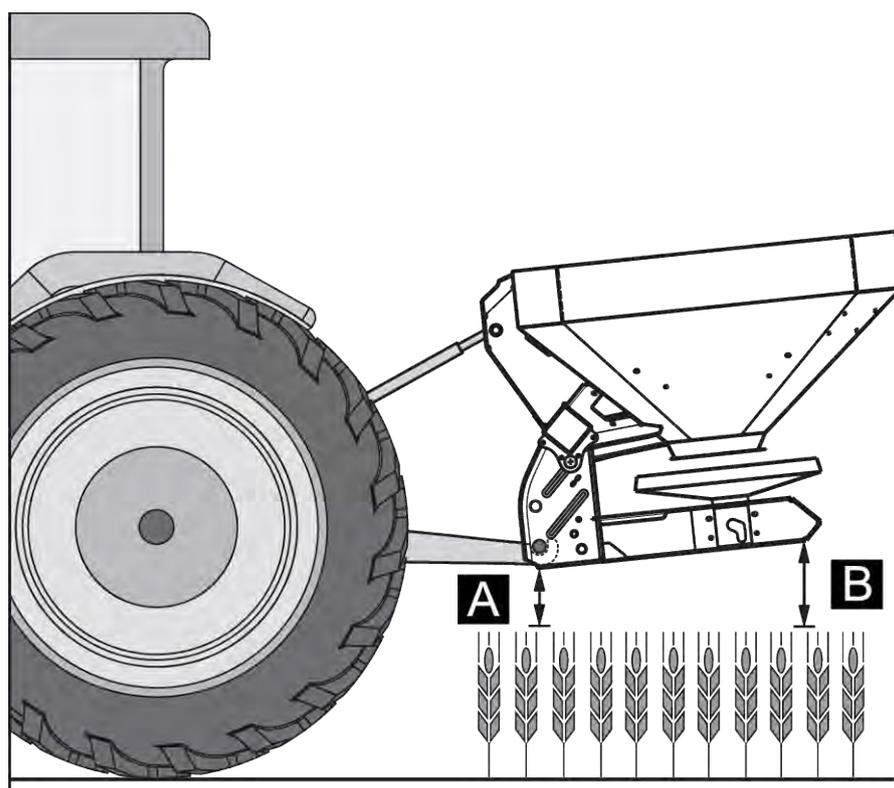
図 26: 下側のロアリンク連結部への機械の取り付け
