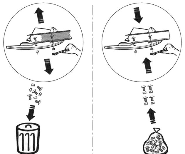
図 64: 新しい自動ロック式ナットを使用
