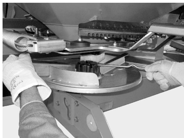
図 37: キャップナットをゆるめる
