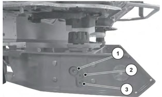
図 71: ギアオイルの充填箇所と放出箇所
