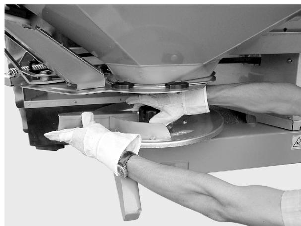
図 50: キャップナットを締め付ける
