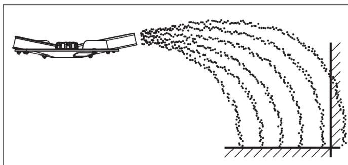
図 29: 通常散布での適量境界散布
