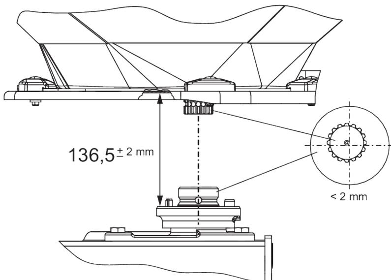
図 59: 散布ディスクハブ位置の確認
