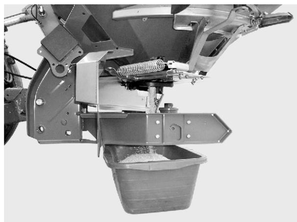
図 49: キャリブレーションテストの実施
