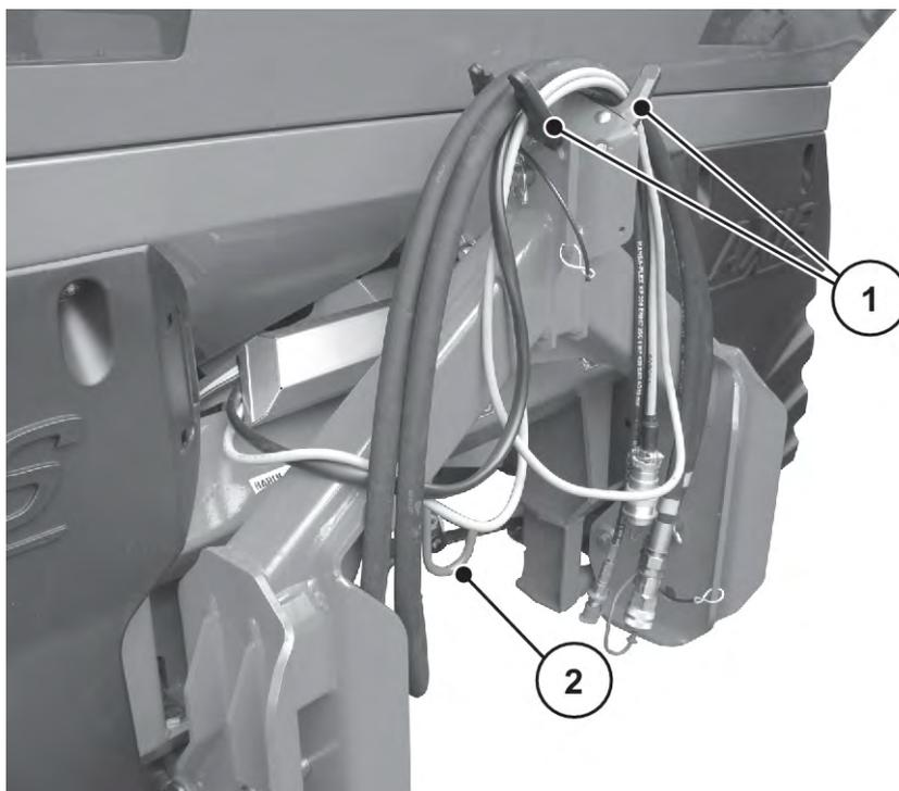
図 21: ケーブルと油圧ホースの収納
