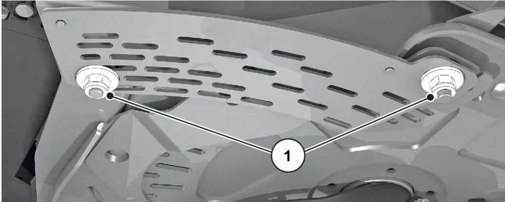
図 67: スケールの固定ネジ
