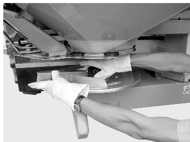
図 38: キャップナットを外す
