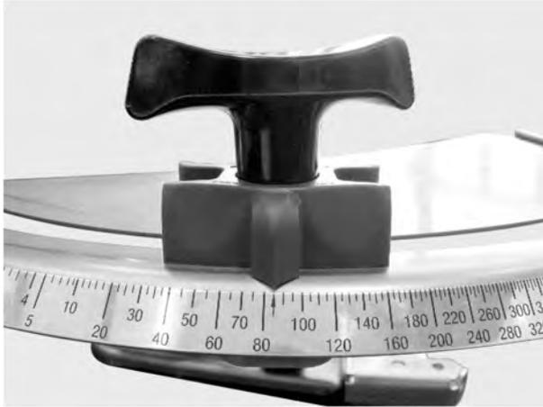
図 66: 計測スライドの設定スケール
