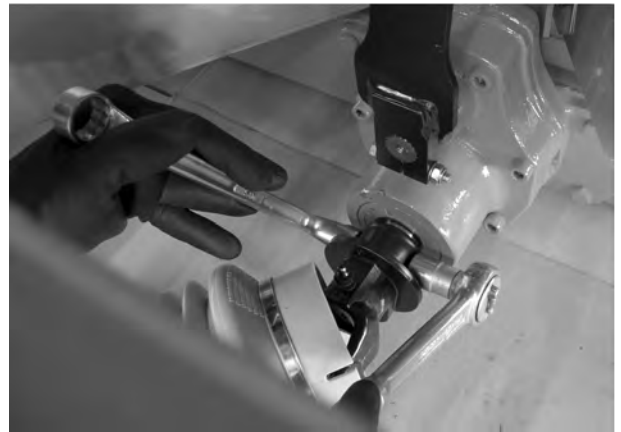
Jn. 13: Kardaanvõlli kinnitamine
