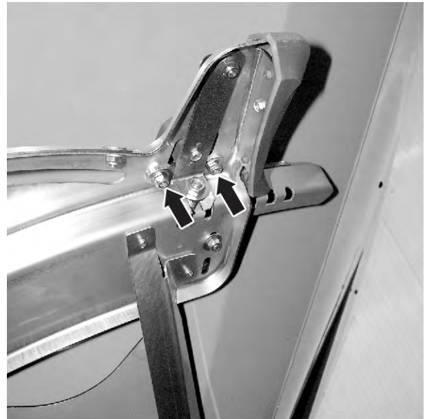
Jn. 70: Äraandmispunkti reguleerimisplaadi avamine
