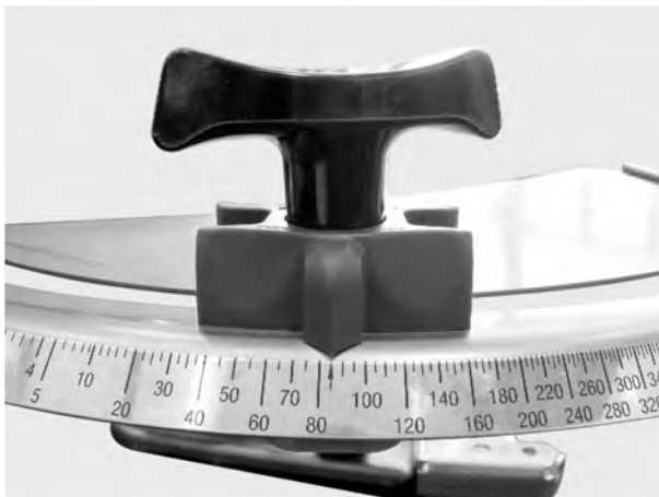
Sl. 66: Podešavanje skale klizača za doziranje
