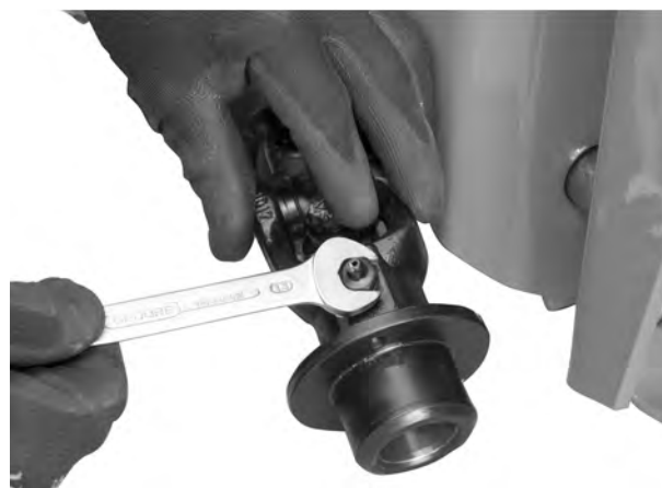
Sl. 11: Otpuštanje priključka za podmazivanje
