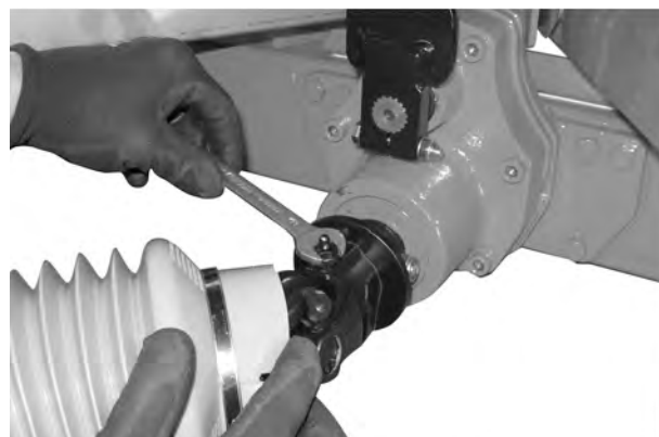
Рис. 14: Затяжка смазочного ниппеля
