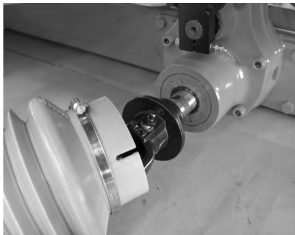
Рис. 12: Надевание карданного вала на конец вала редуктора
