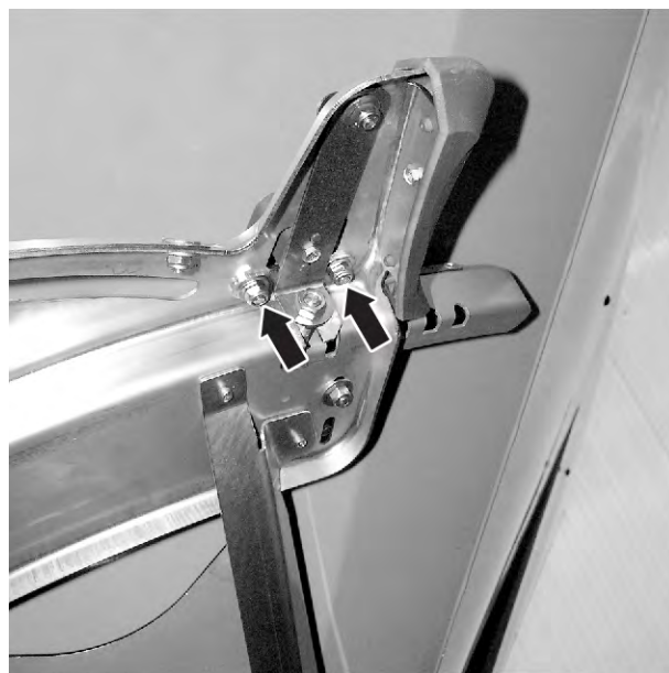
Fig. 70: Løsne justeringsplate utmatingspunkt
