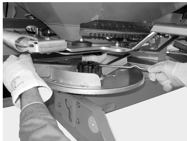
Fig. 37: Løsning af kalotmøtrikken
