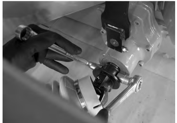
Ilust. 13: Fijar el eje articulado
