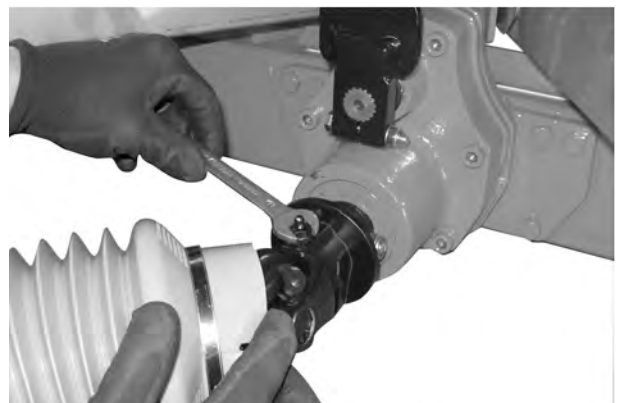
Ilust. 14: Apretar la boquilla de lubricación
