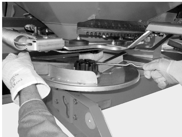
Fig. 37: Slăbiți piulița cu pălărie
