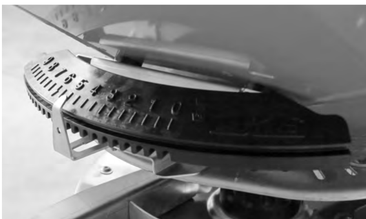
Fig. 40: Afișare pentru punctul de alimentare (exemplu)
