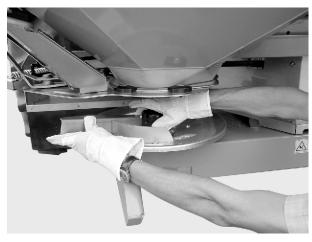
Fig. 50: Tighten the cap nut
