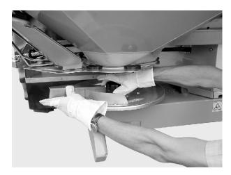
Fig. 38: Unscrew the cap nut
