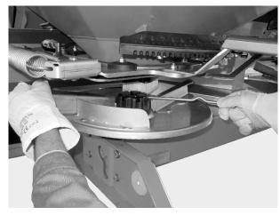
Fig. 37: Loosen the cap nut
