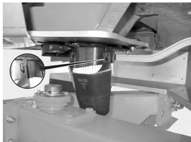
Fig. 48: Attacher la goulotte du contrôle de débit
