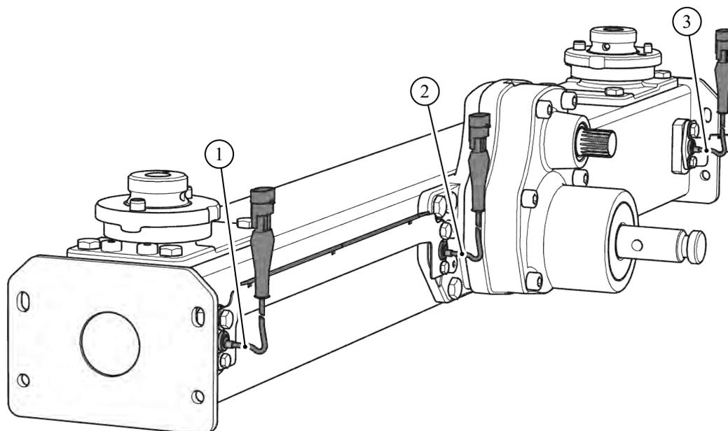
Abb. 7: Massenstromregelung durch Messung des Drehmoments der Wurfscheiben
