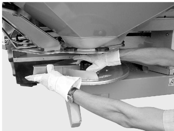
Abb. 50: Hutmutter anziehen
