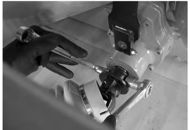
*Abb. 13: Gelenkwelle befestigen*
