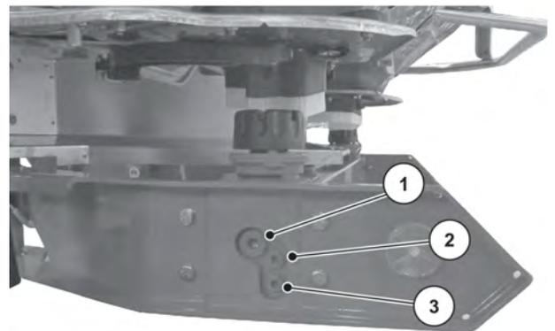
Abb. 71: Einfüll- und Ablassstellen für Getriebeöl
