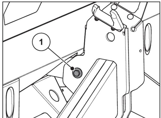
Abb. 53: Befestigung des Zugstabes am Wiegerahmen
