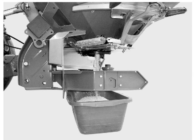
Abb. 49: Abdrehprobe durchführen
