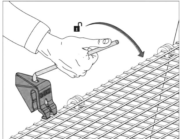
Abb. 56: Schutzgitterverriegelung öffnen
