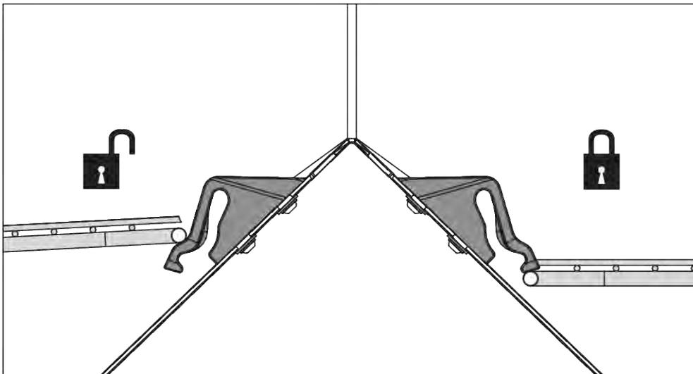
Abb. 55: Schutzgitterverriegelung offen/geschlossen
