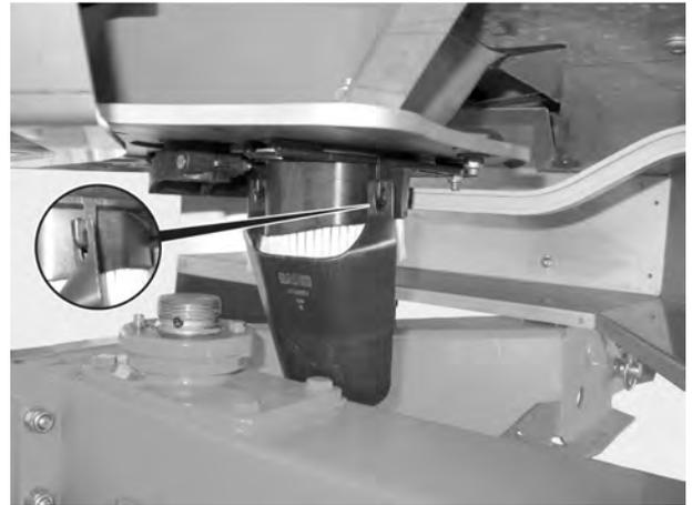
Abb. 48: Abdrehprobenrutsche einhängen
