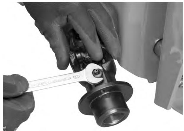
Abb. 11: Schmiernippel lösen
