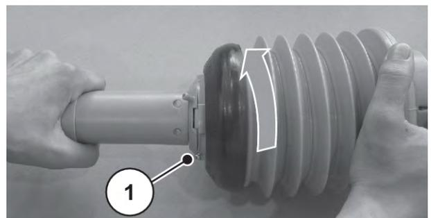
Abb. 10: Gelenkwellenschutz lösen
