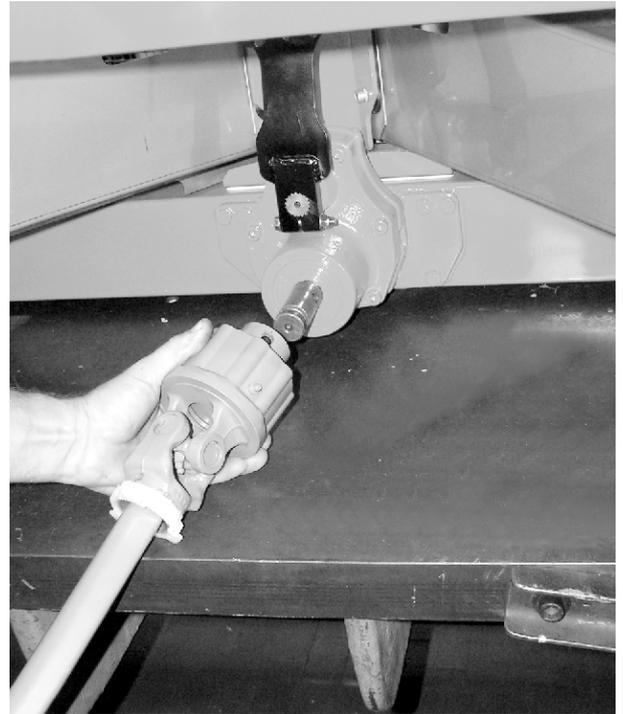
Abb. 17: Gelenkwelle auf Getriebezapfen aufstecken
