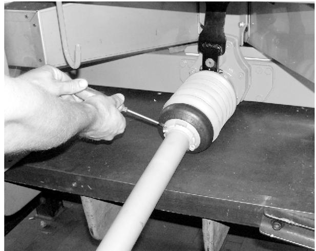
Abb. 20: Gelenkwellenschutz sichern
