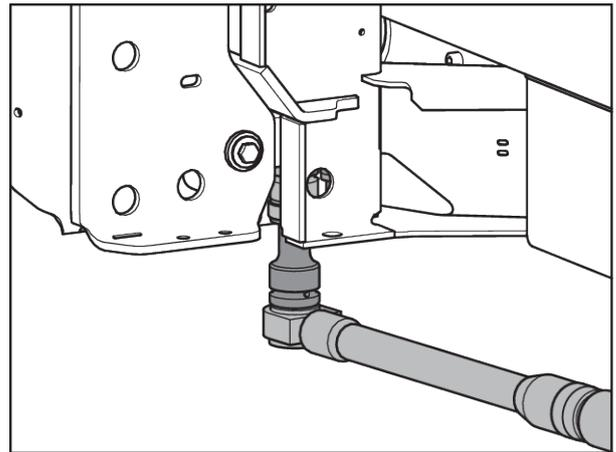
Abb. 52: Befestigung der Wiegezeile (in Fahrtrichtung links)
