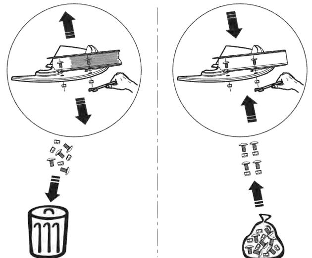
Abb. 64: Neue selbstsichernde Muttern verwenden
