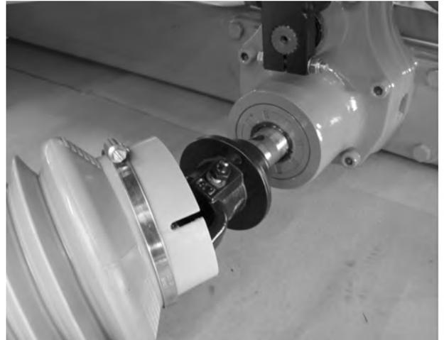
*Abb. 12: Gelenkwelle auf Getriebezapfen aufstecken*
