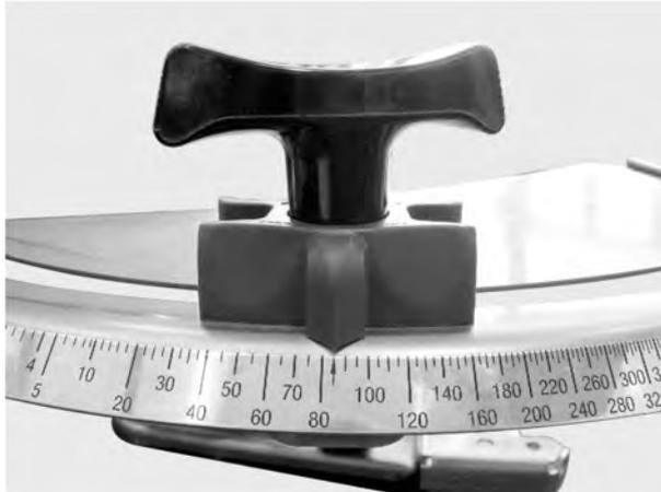
Abb. 66: Skala Dosierschiebereinstellung
