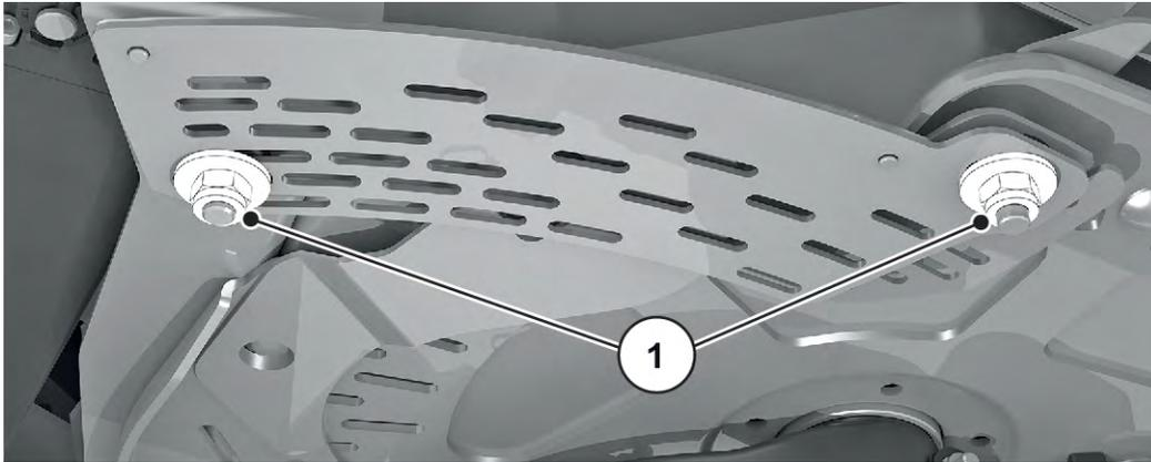
Abb. 67: Befestigungsschrauben der Skala
