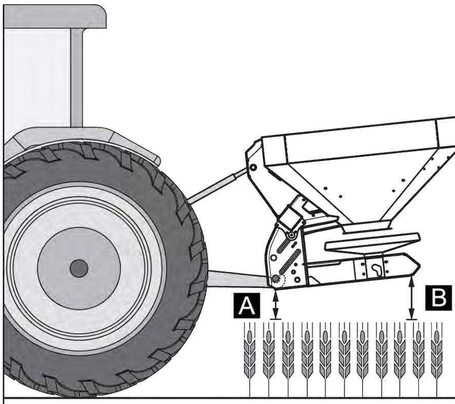
Abb. 26: Anbau der Maschine an den unteren Unterlenkerkuppelpunkt
