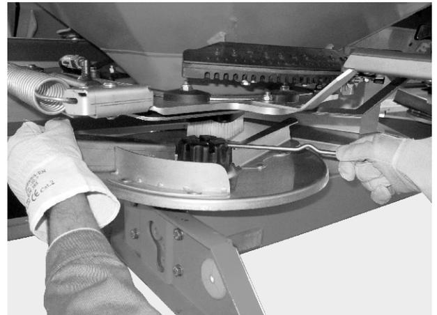
Abb. 47: Hutmutter lösen
