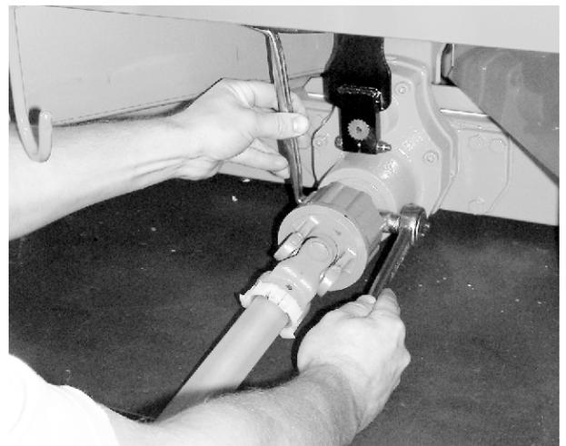
Abb. 18: Gelenkwelle befestigen
