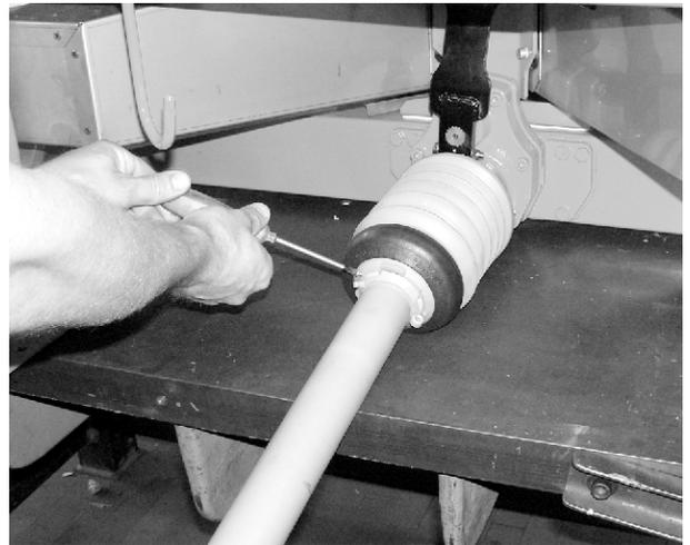
Abb. 16: Gelenkwellenschutz sichern
