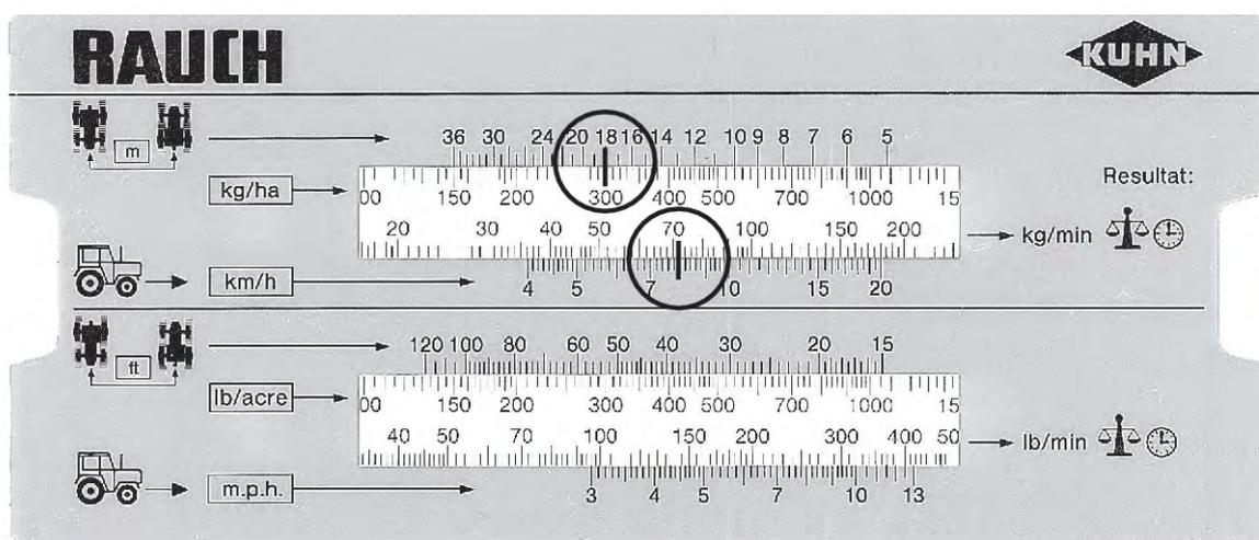
Abb. 45: Skala zur Ermittlung der Soll-Auslaufmenge pro Minute
