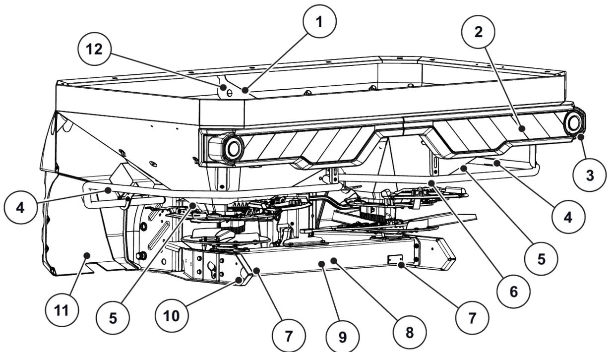
Abb. 3: Schutzeinrichtungen, Aufkleber Warn- und Instruktionshinweise, Rückseite
