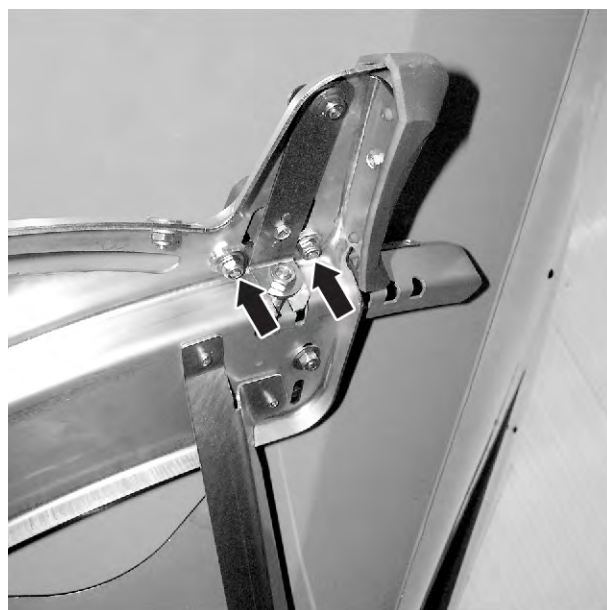
Рис. 70: Ослаблення юстувальної пластини точки подачі
