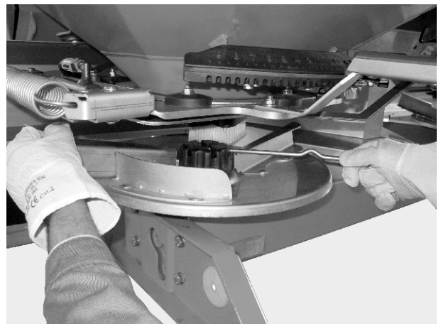
Att. 47: Kupoluzgriežņa atskrūvēšana
